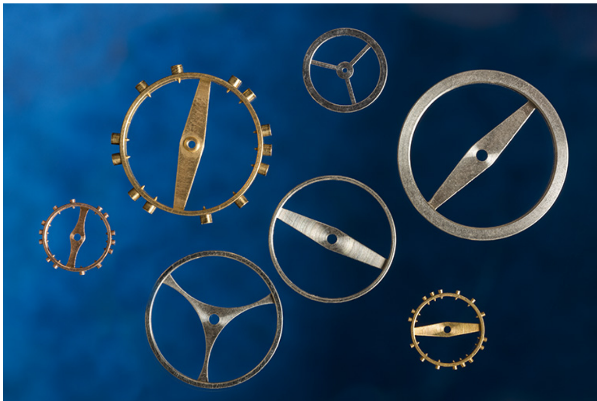
Exemple de composants fabriqués à l'usine : balanciers de montre.
