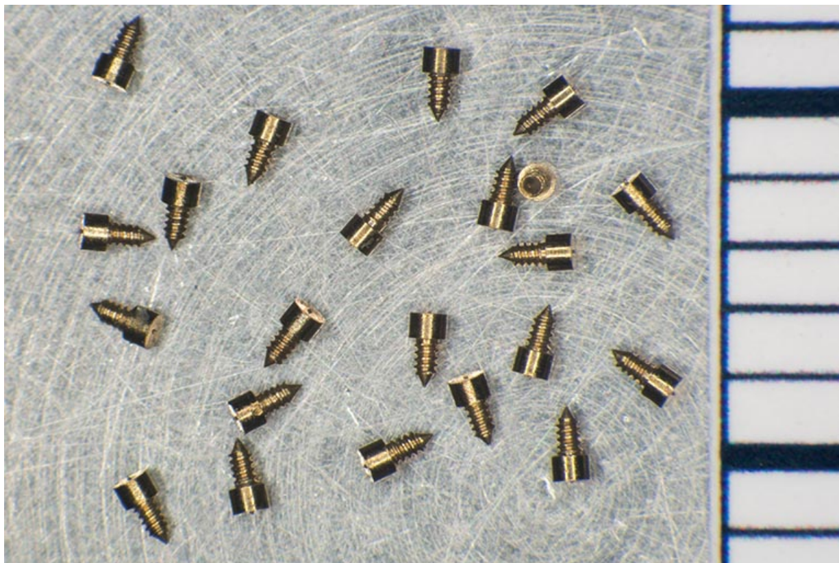
Exemple de composants fabriqués à l'usine : vis destinées au balancier de montre (avec échelle centimétrique). 25, Villers-le-Lac, 3 rue des Essarts
