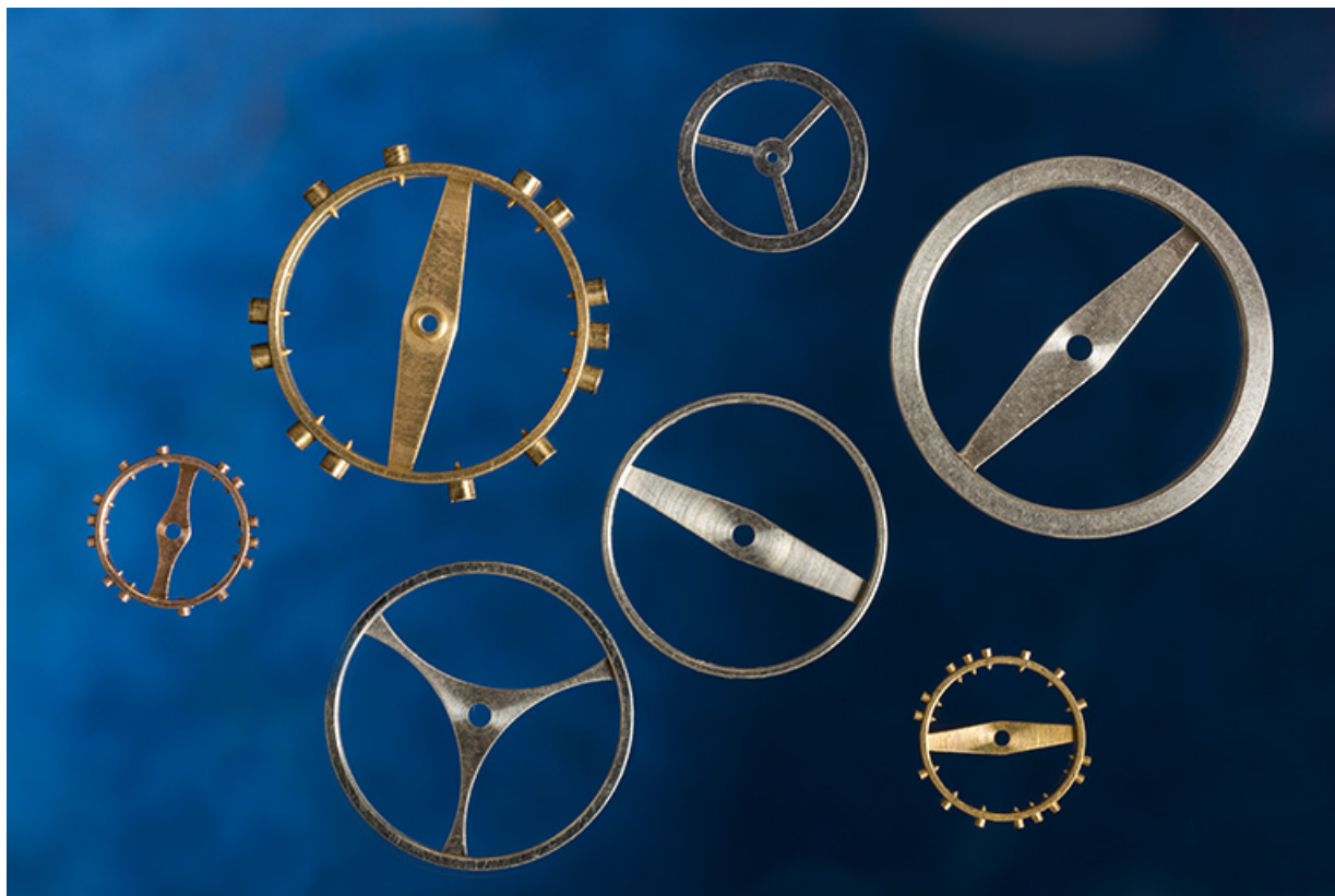
Exemple de composants fabriqués à l'usine : balanciers de montre. 25, Villers-le-Lac, 3 rue des Essarts
