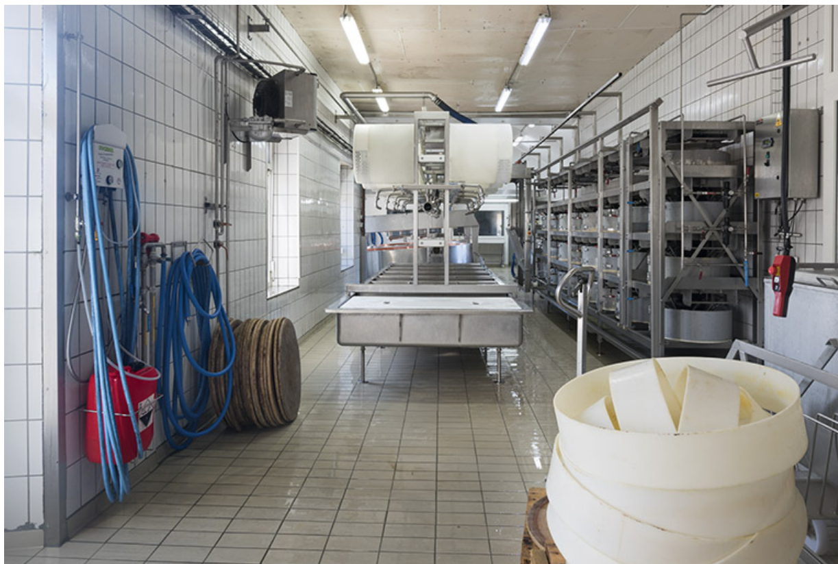
Atelier de fabrication : banc de soutirage et installation de pressage.
