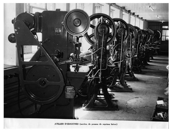
Atelier d'ébauches (section de presses de reprises laiton), vers 1950.
