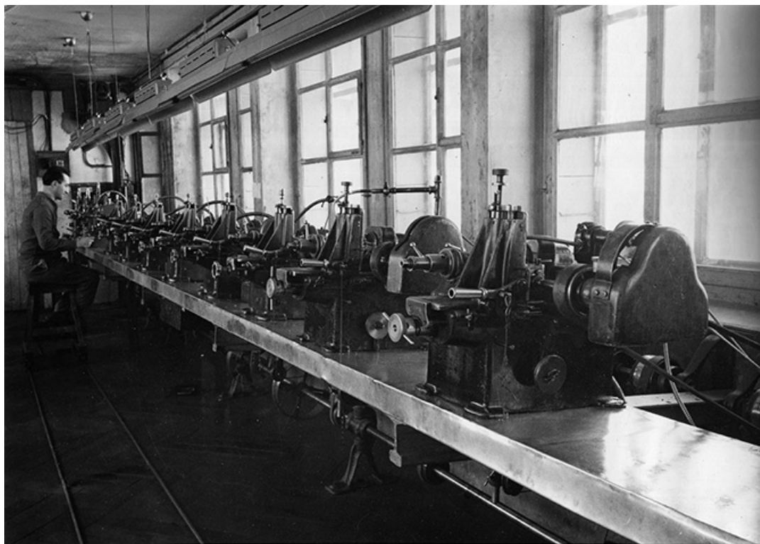
ATELIER DE TAILLAGE (machines à tailler par génération)
