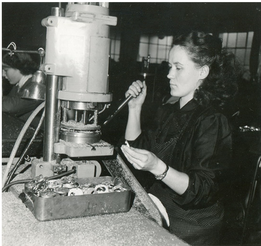
[Une ouvrière au travail : usinage de platines], vers 1950 ?
