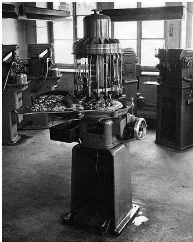
Perceuse semi-automatique multibroche auto-contrôlée à très grande production
