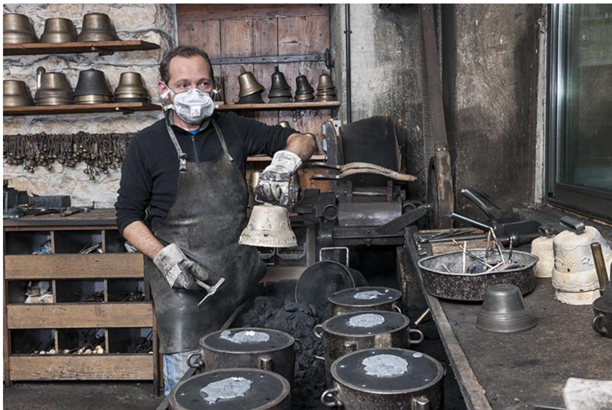
Démoulage. Extraction de la cloche (5).
