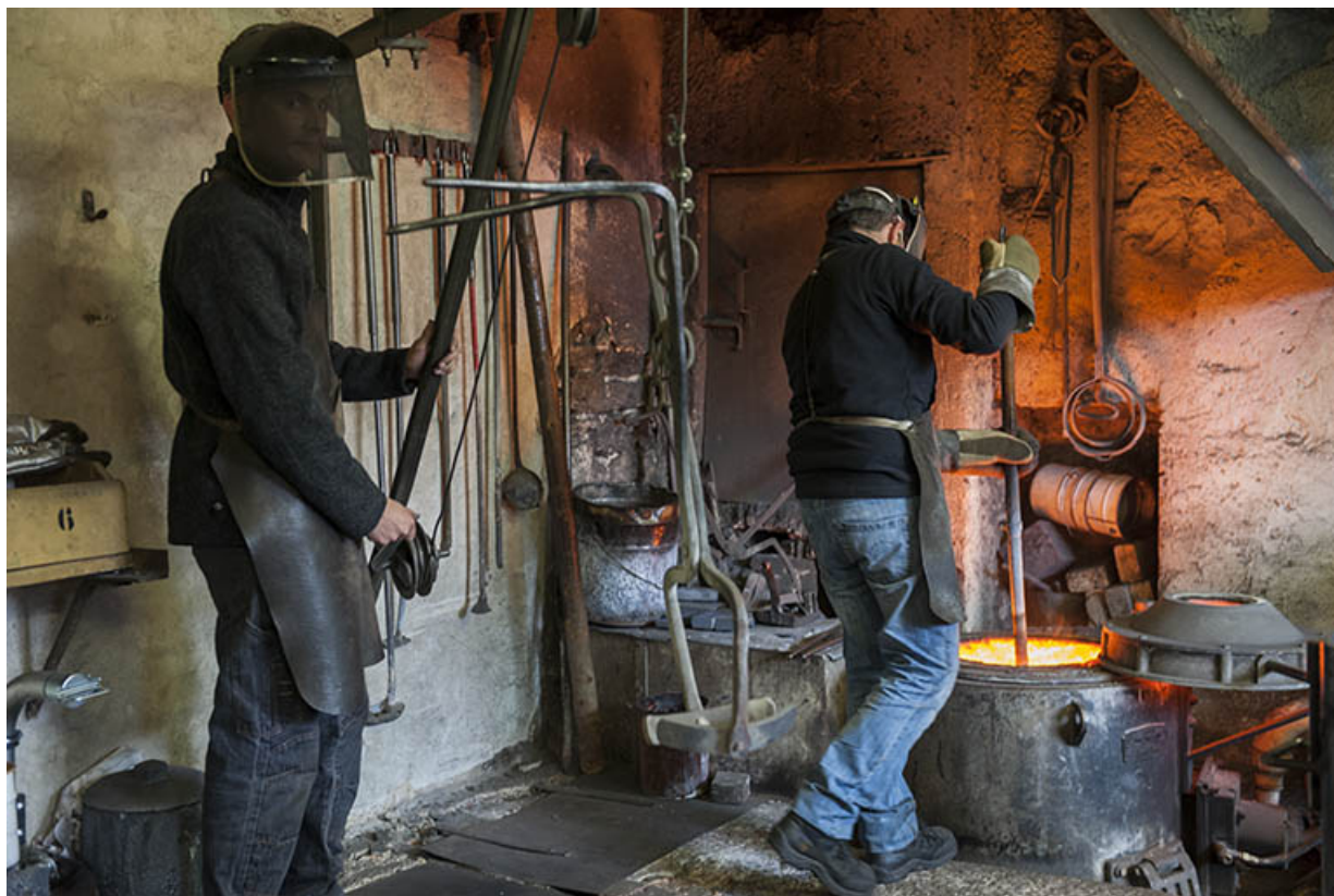
Préparation de la potence pour lever la poche de bronze en fusion (creuset). 25, Labergement-Sainte-Marie, 15 rue de la Fonderie
