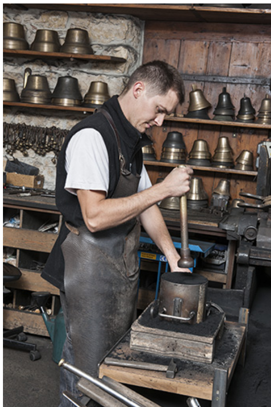
Moulage. Tassage au fouloir métallique (2).
