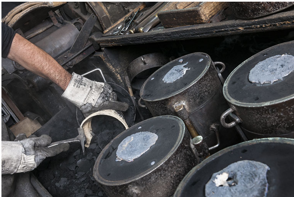
Démoulage. Extraction de la cloche (1).
