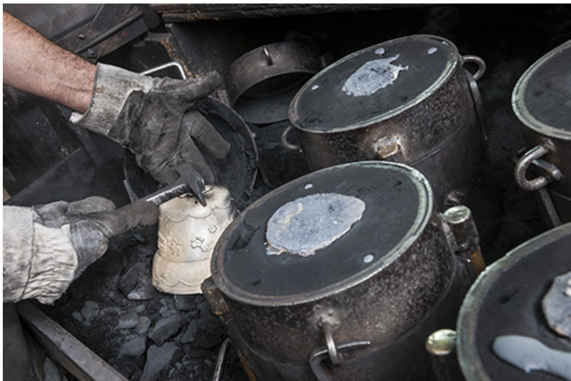
Démoulage. Extraction de la cloche (2).
