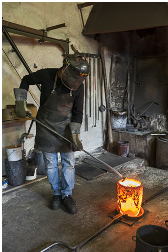
Poche de bronze en fusion. L'opérateur retire le laitier (scories) (1). 25, Labergement-Sainte-Marie, 15 rue de la Fonderie
