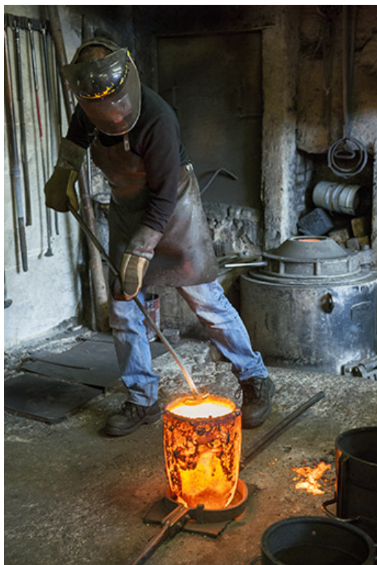
Poche de bronze en fusion. L'opérateur retire le laitier (scories) (2). 25, Labergement-Sainte-Marie, 15 rue de la Fonderie
