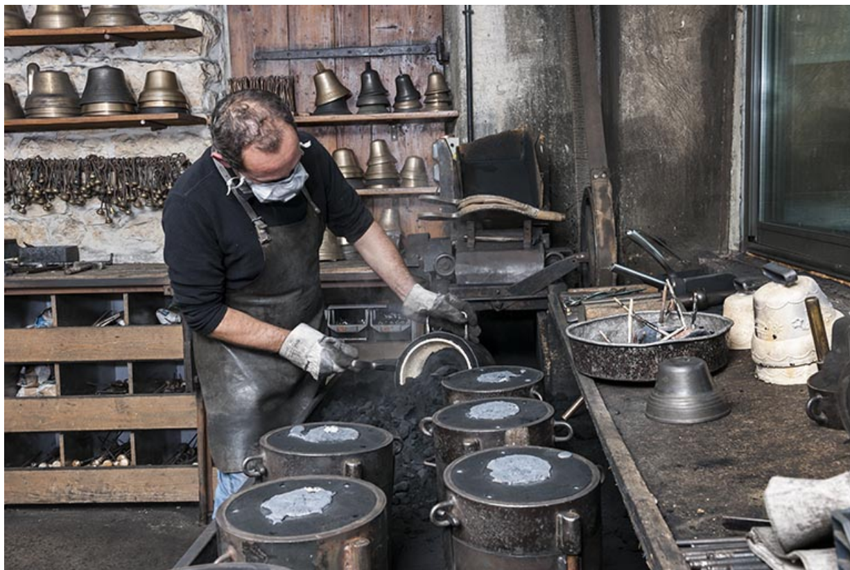
Démoulage. Extraction de la cloche (3).
