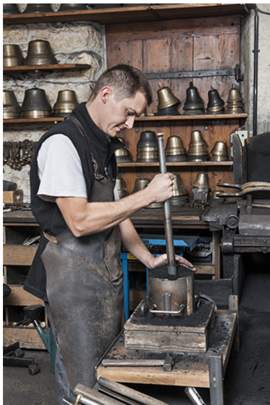
Moulage. Tassage au fouloir métallique (1).
