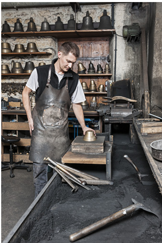
Moulage. Positionnement du modèle (donne l'empreinte extérieure).
