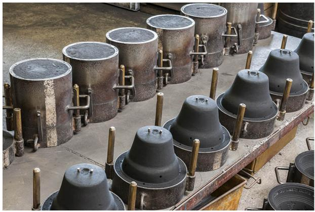
Châssis et moulages avant assemblage.
