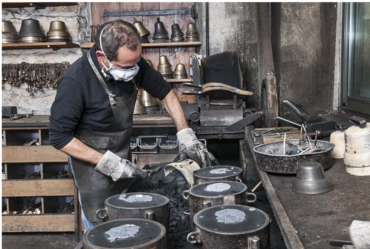
Démoulage. Extraction de la cloche (4).
