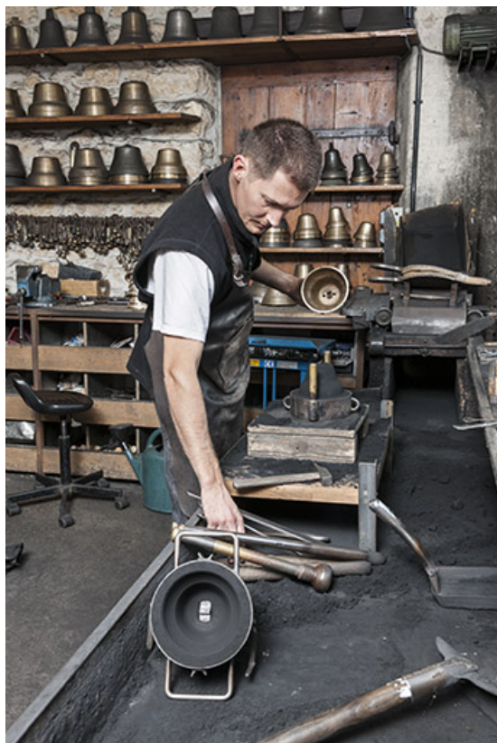
Moulage. Séparation du châssis pour retirer le modèle.
