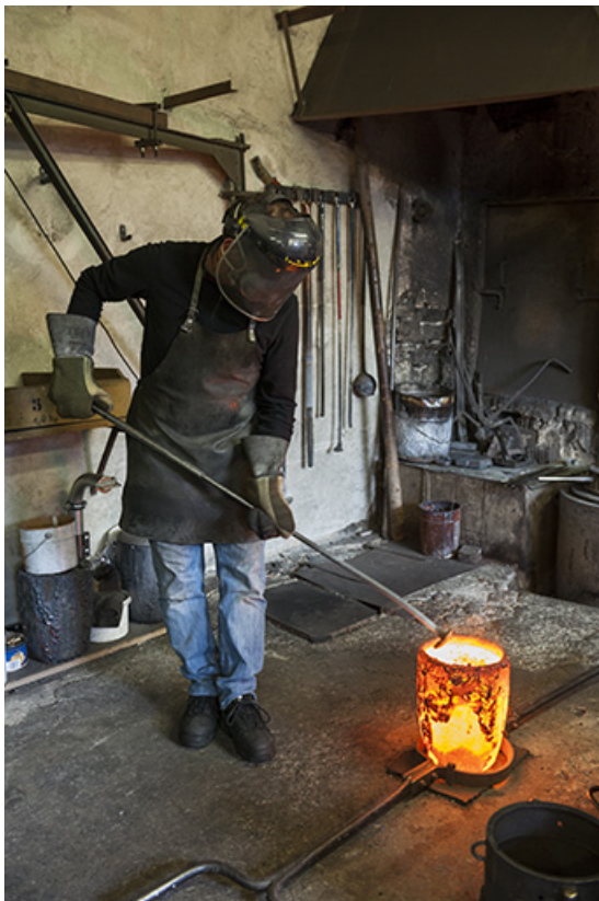
Poche de bronze en fusion. L'opérateur retire le laitier (scories) (1).
