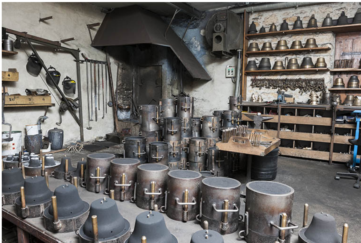
Atelier de fonderie : moulages, châssis, foyer et modèles.
