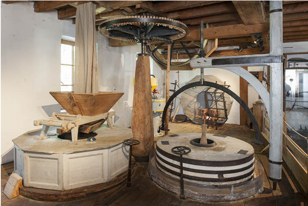
Premier étage. Meules, potence et transmission.
