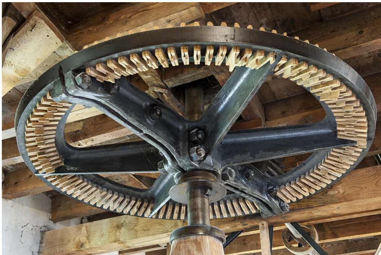
Roue métallique engrenée de dents (alluchons) en bois, appelée rouet. 25, Métabief, 36 rue du Village
