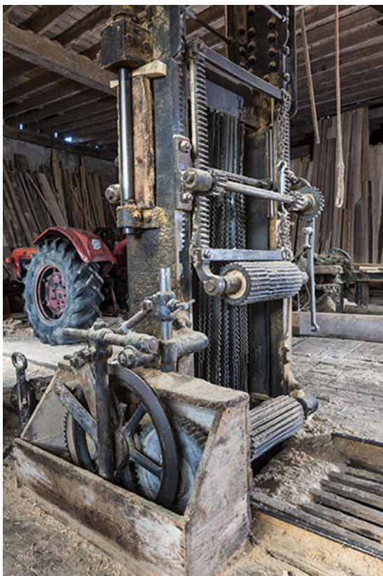
Châssis de scie vu de trois quarts. Au premier plan : système d'entraînement. 25, Chapelle-des-Bois, lieudit : Les Mortes
