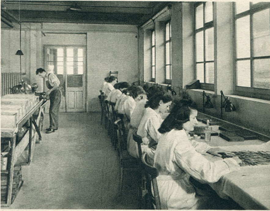
MAICHE Préparation des pierres pour le perçage
