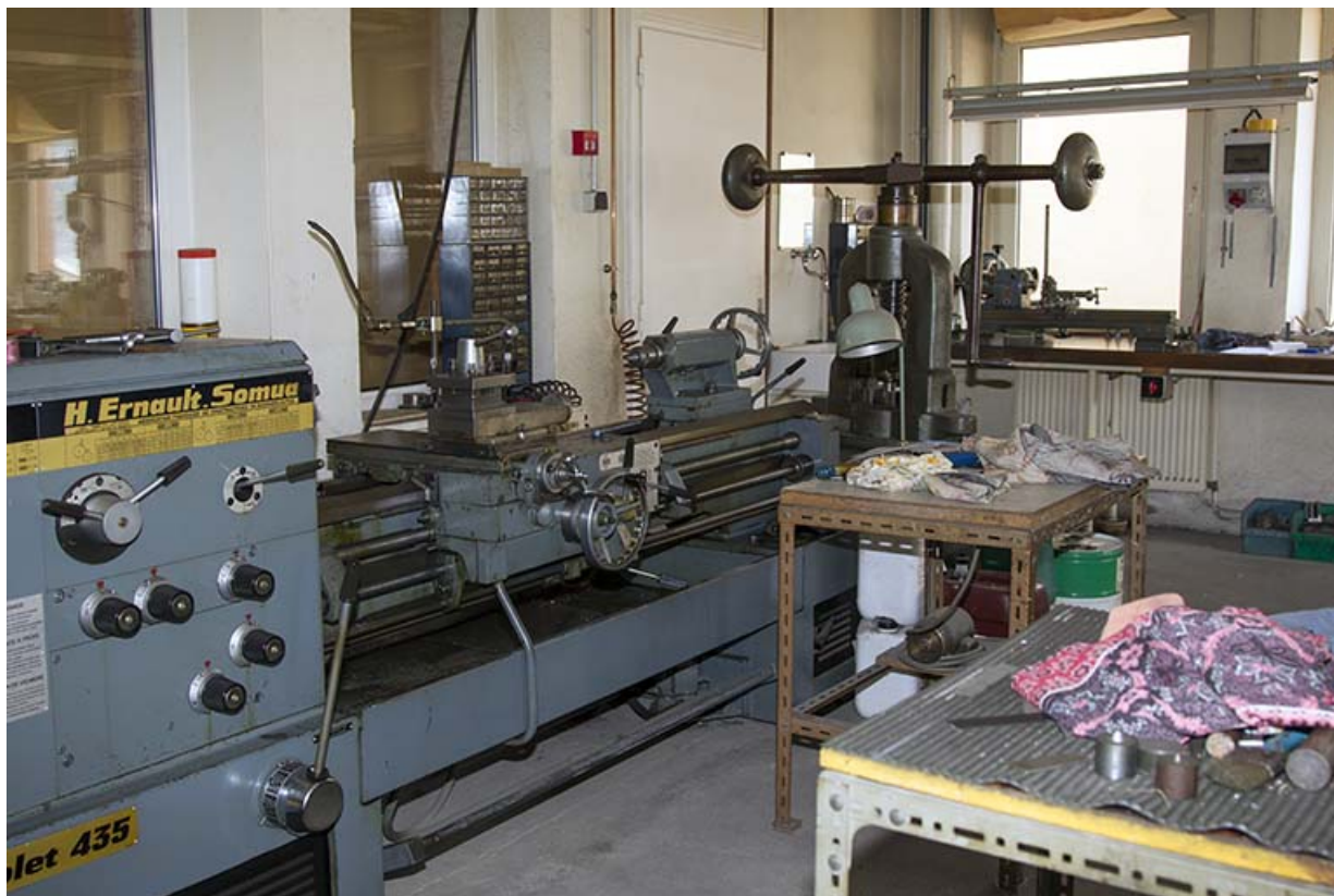
Usine, rez-de-chaussée : tour et grosse presse à balancier. 25, Maîche, 7-9 rue du Mont
