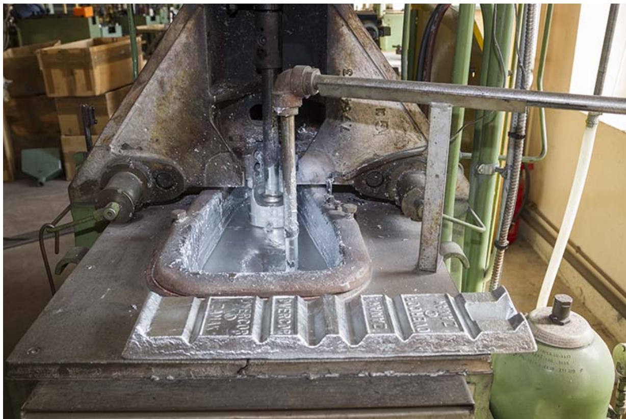
Usine, rez-de-chaussée : machine avec creuset contenant du métal fondu. 25, Maîche, 7-9 rue du Mont
