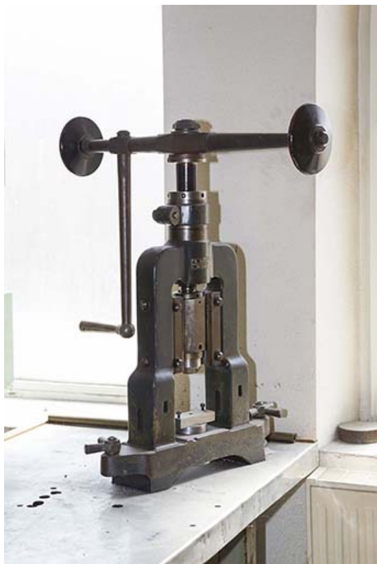
Usine, rez-de-chaussée : petite presse à balancier. 25, Maïche, 7-9 rue du Mont
