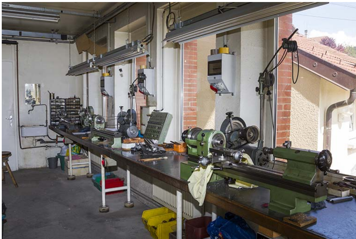
Usine, rez-de-chaussée : établi à l'arrière des fenêtres, supportant des tours. 25, Maîche, 7-9 rue du Mont
