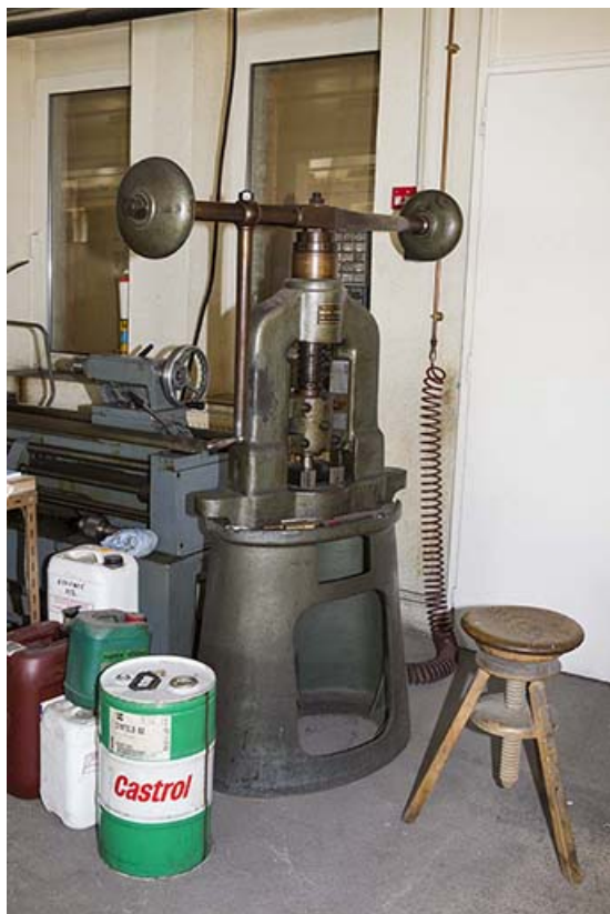
Usine, rez-de-chaussée : grosse presse à balancier. 25, Maîche, 7-9 rue du Mont
