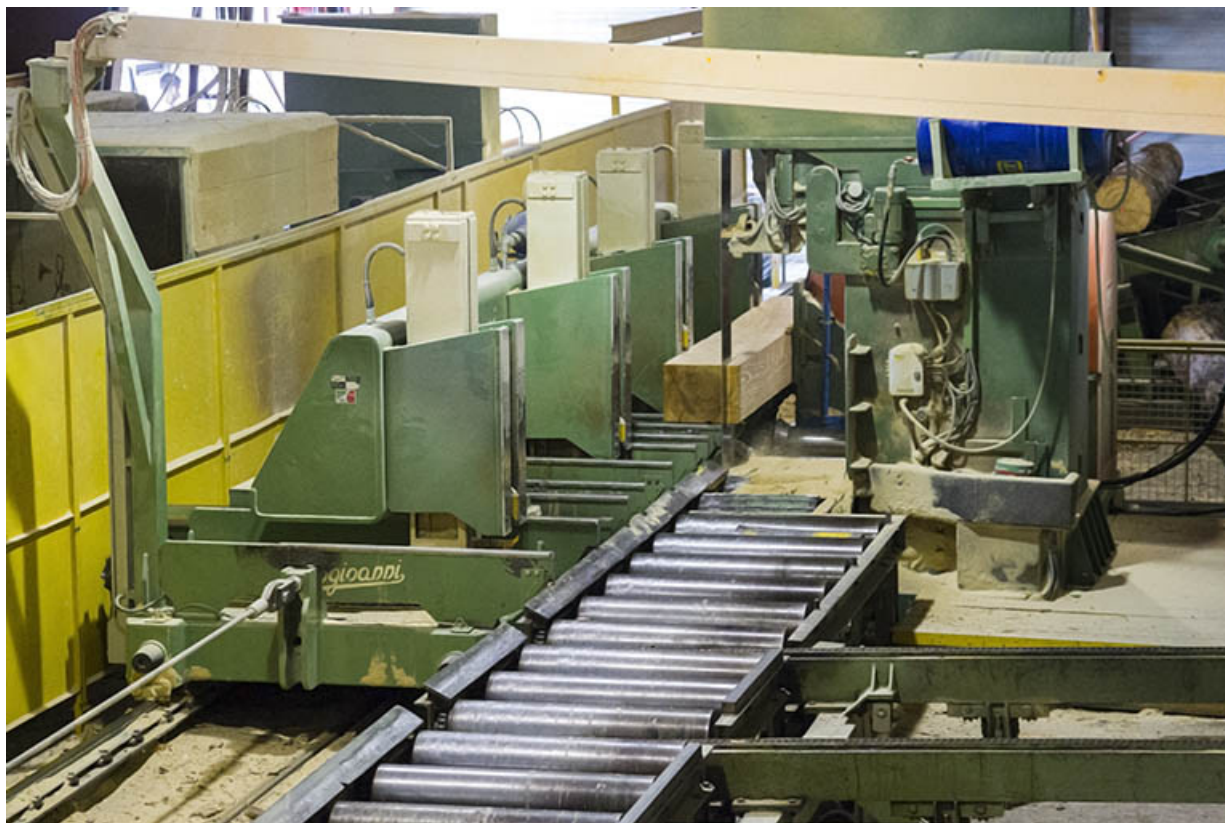
Atelier de débitage (N) : scie à ruban Bongioanni et son chariot, vus de l'aval. 25, Maïche rue de la Scierie
