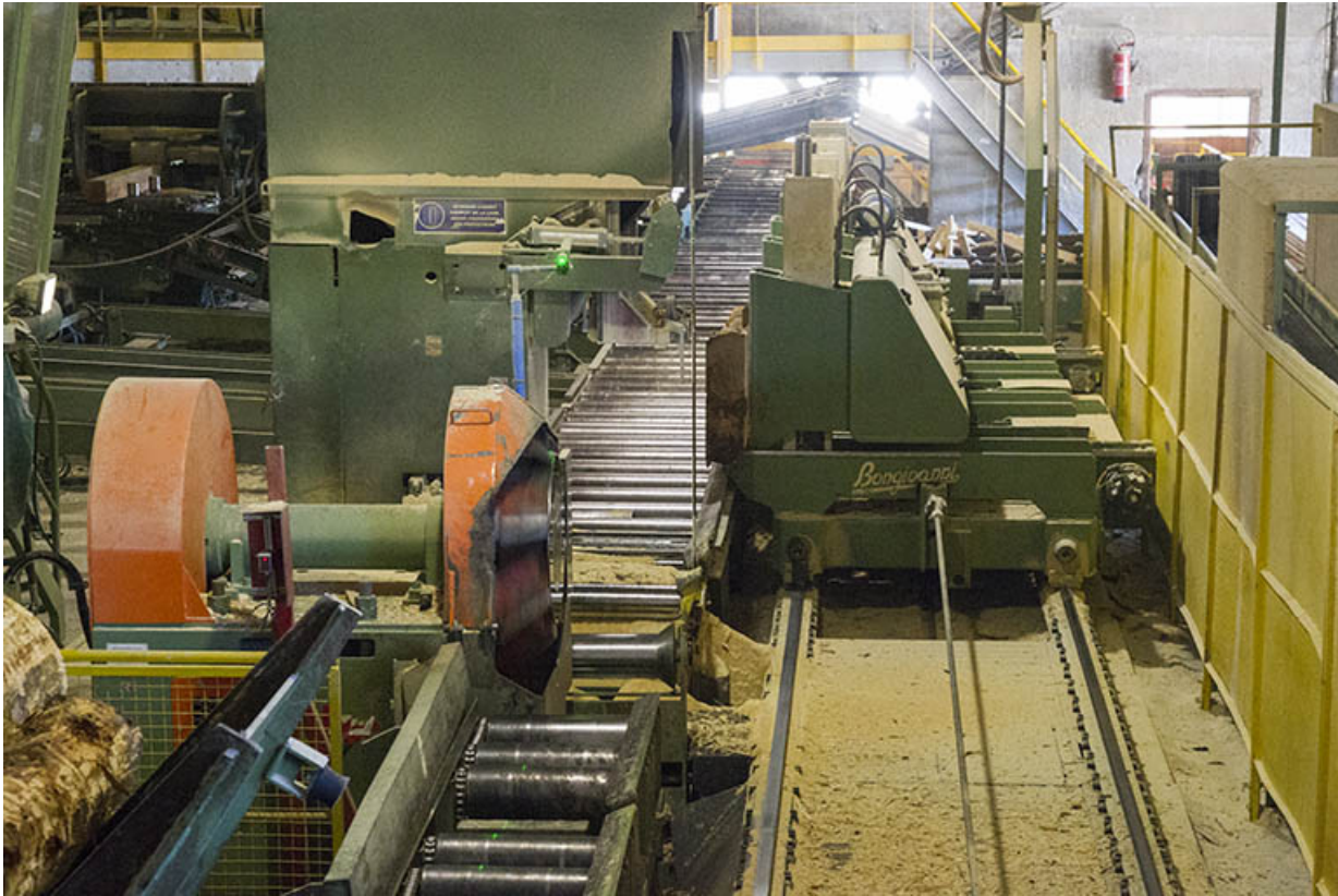
Atelier de débitage (N) : scie à ruban Bongioanni et son chariot, vus de l'amont. 25, Maîche rue de la Scierie
