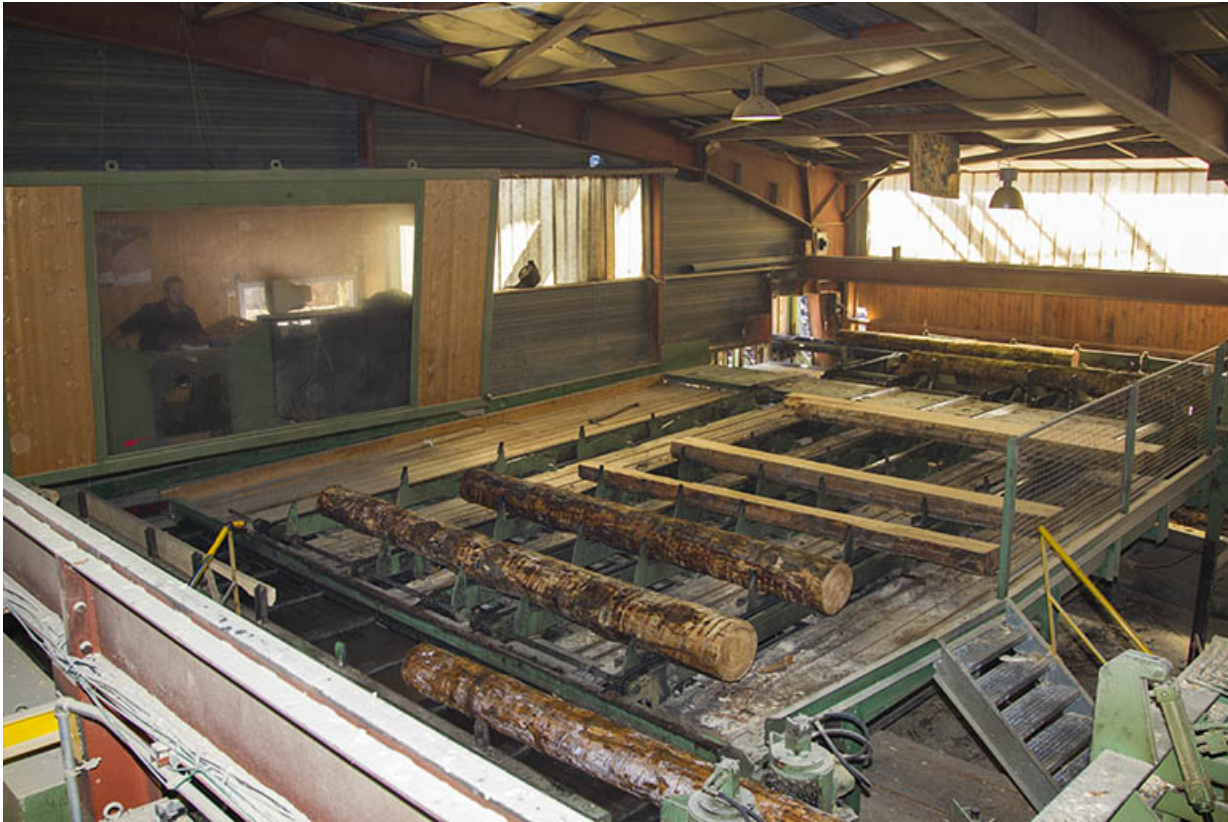
Atelier de débitage (N) : poste de commande et convoyeur de grumes. 25, Maîche rue de la Scierie
