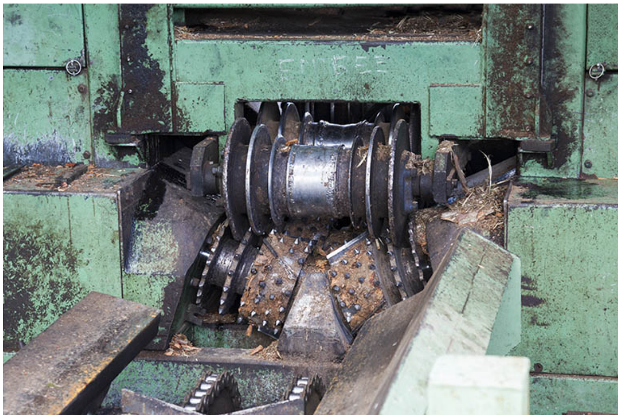
Installation de billonnage : détail des rouleaux.
