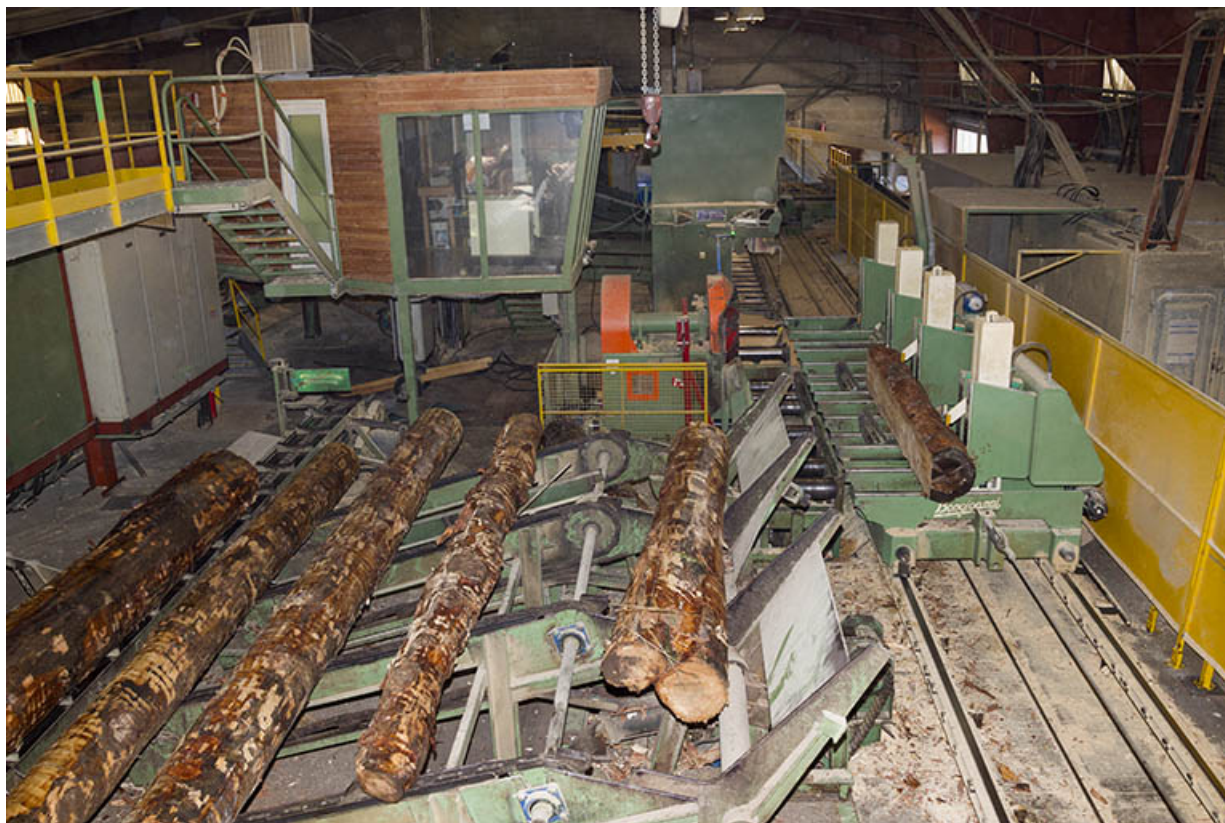
Atelier de débitage (N) : scie à ruban Bongioanni, vue de l'amont. 25, Maîche rue de la Scierie
