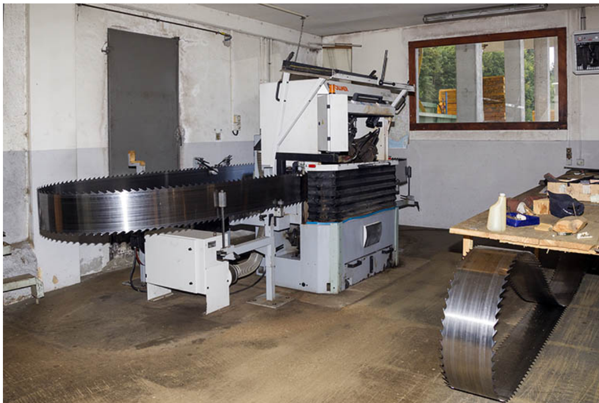
Atelier d'affûtage (K) : machine pour l'affûtage des lames de scie à ruban à double denture. 25, Maîche rue de la Scierie
