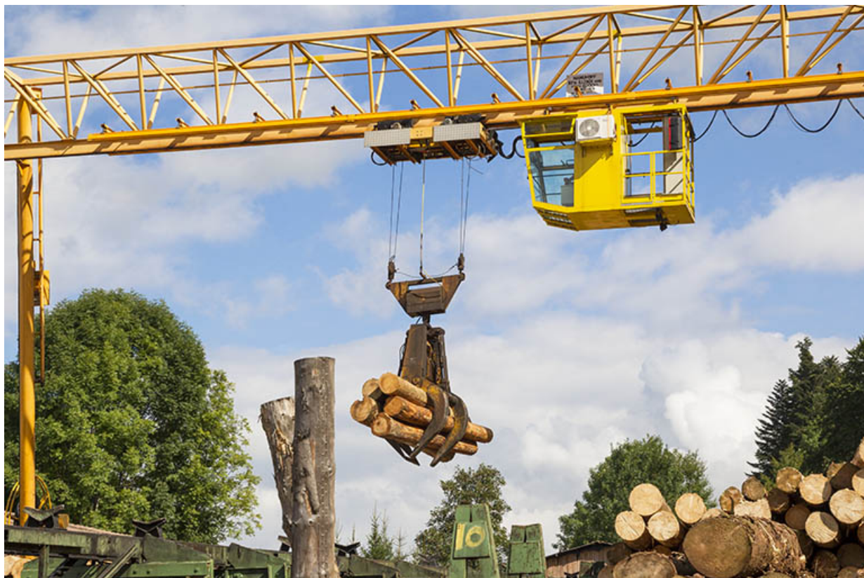
Portique roulant : transport de grumes.
