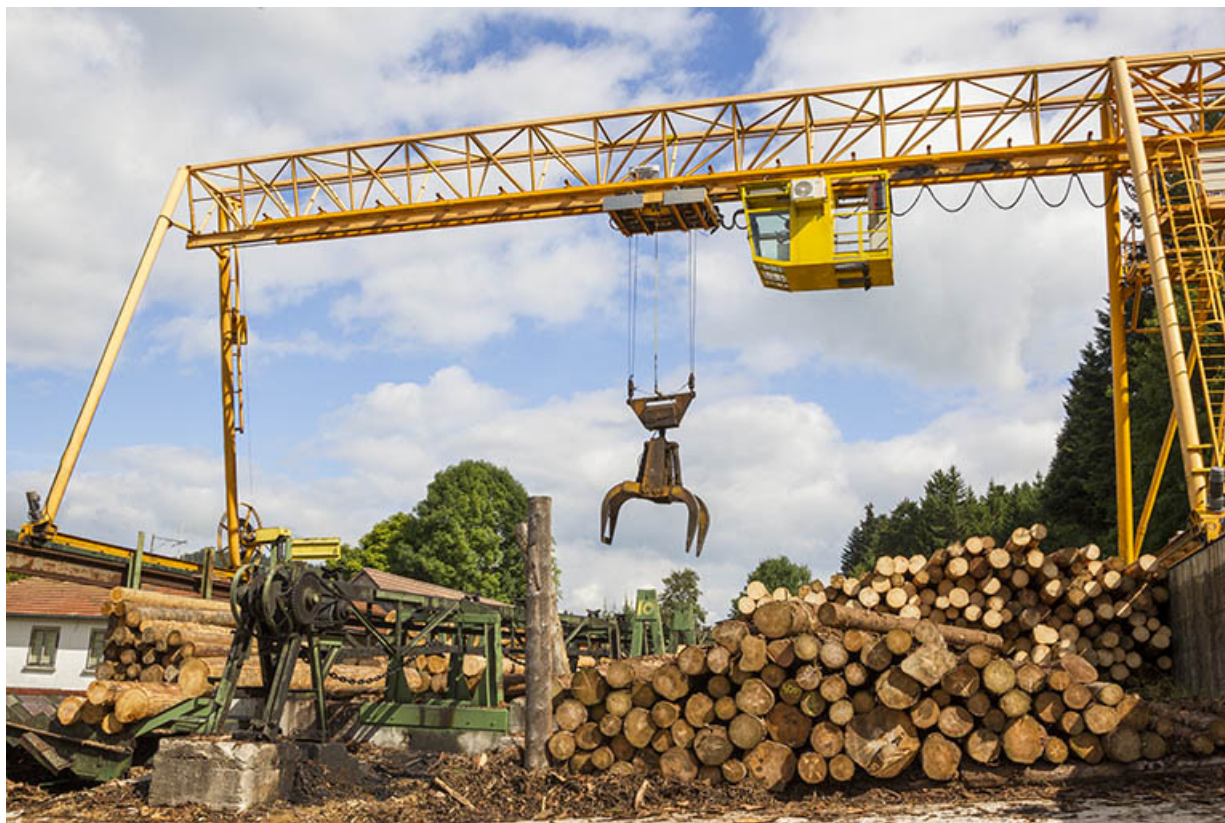
Portique roulant : déplacement de la pince.
