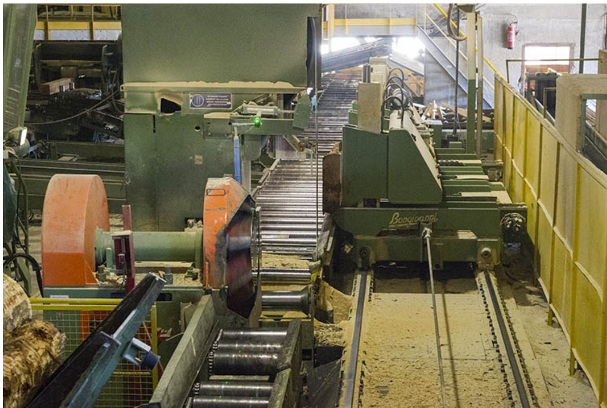
Atelier de débitage (N) : scie à ruban Bongianni et son chariot, vus de l'amont. 25, Maïche rue de la Scierie
