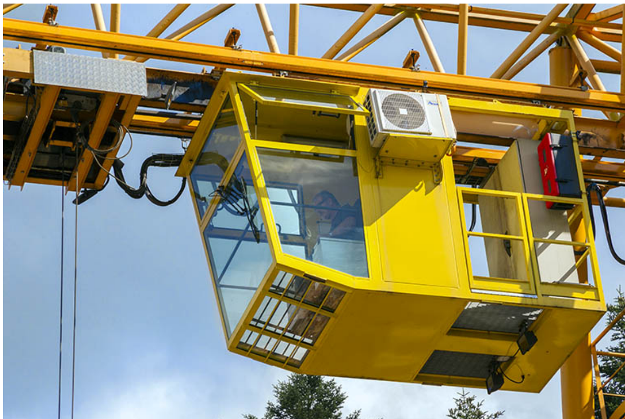
Portique roulant : cabine de commande.
