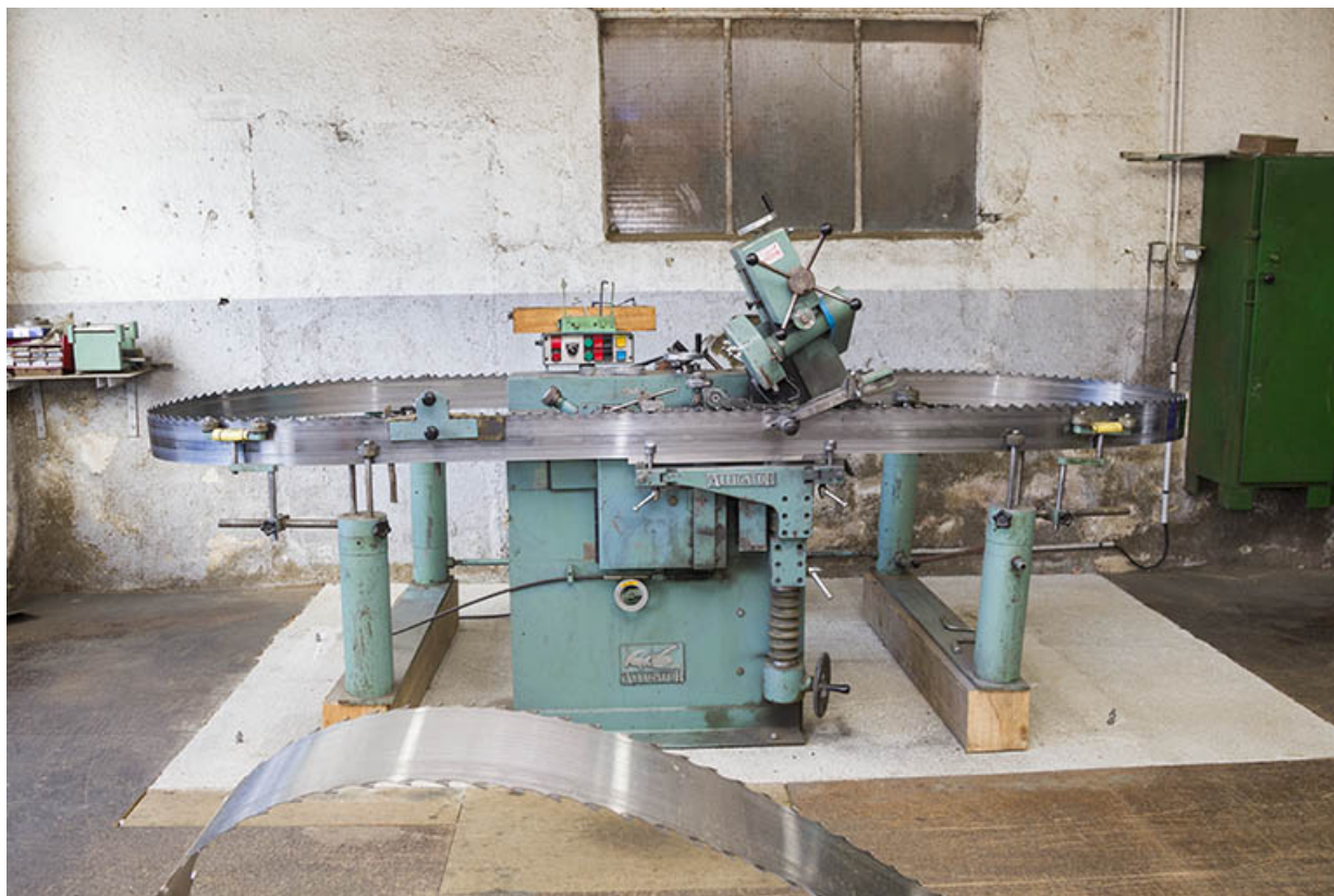
Atelier d'affûtage (K) : machine pour l'affûtage des lames de scie à ruban. 25, Maïche rue de la Scierie
