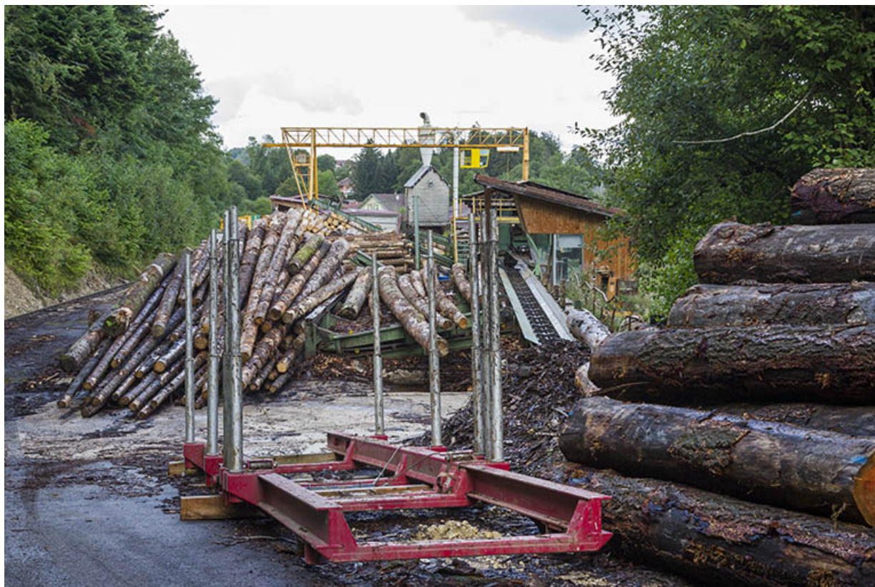
Aire des matières premières et installation de billonnage.
