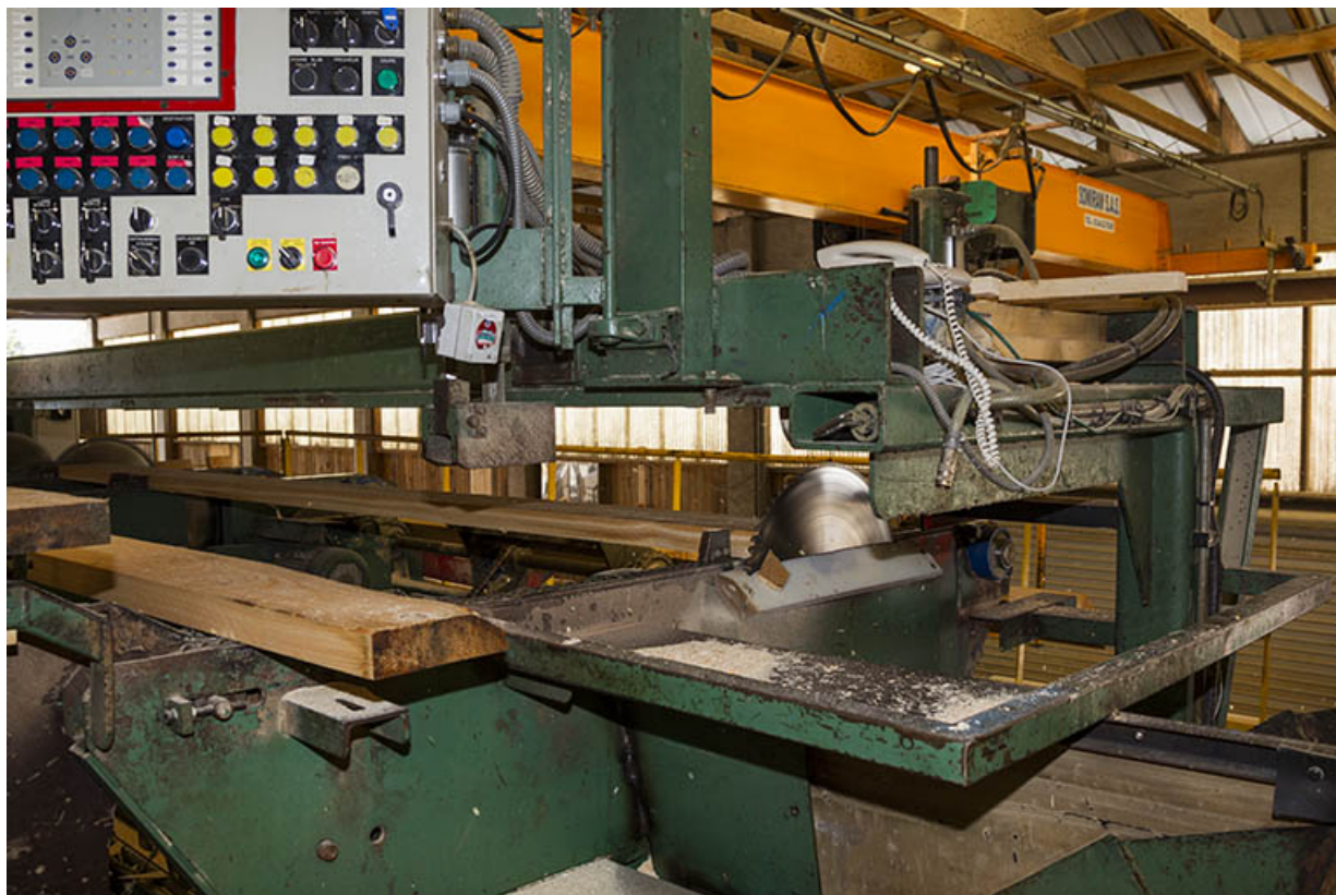
Atelier de triage et d'empilage (E) : scie circulaire de l'installation de sciage. 25, Maïche rue de la Scierie
