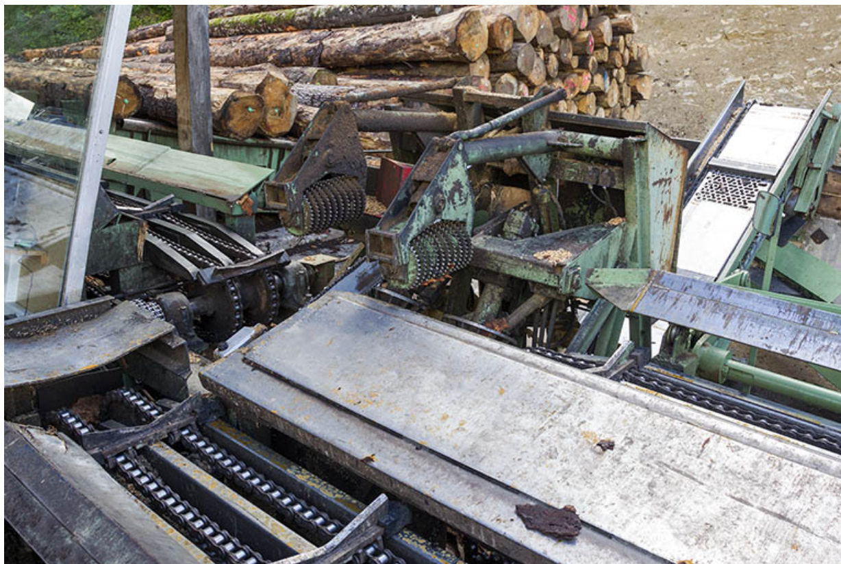
Installation de billonnage. 25, Maïche rue de la Scierie
