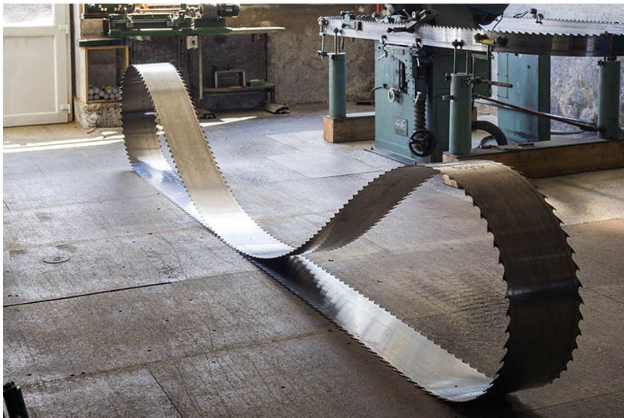
Atelier d'affûtage (K) : lame de scie à ruban à double denture. 25, Maîche rue de la Scierie
