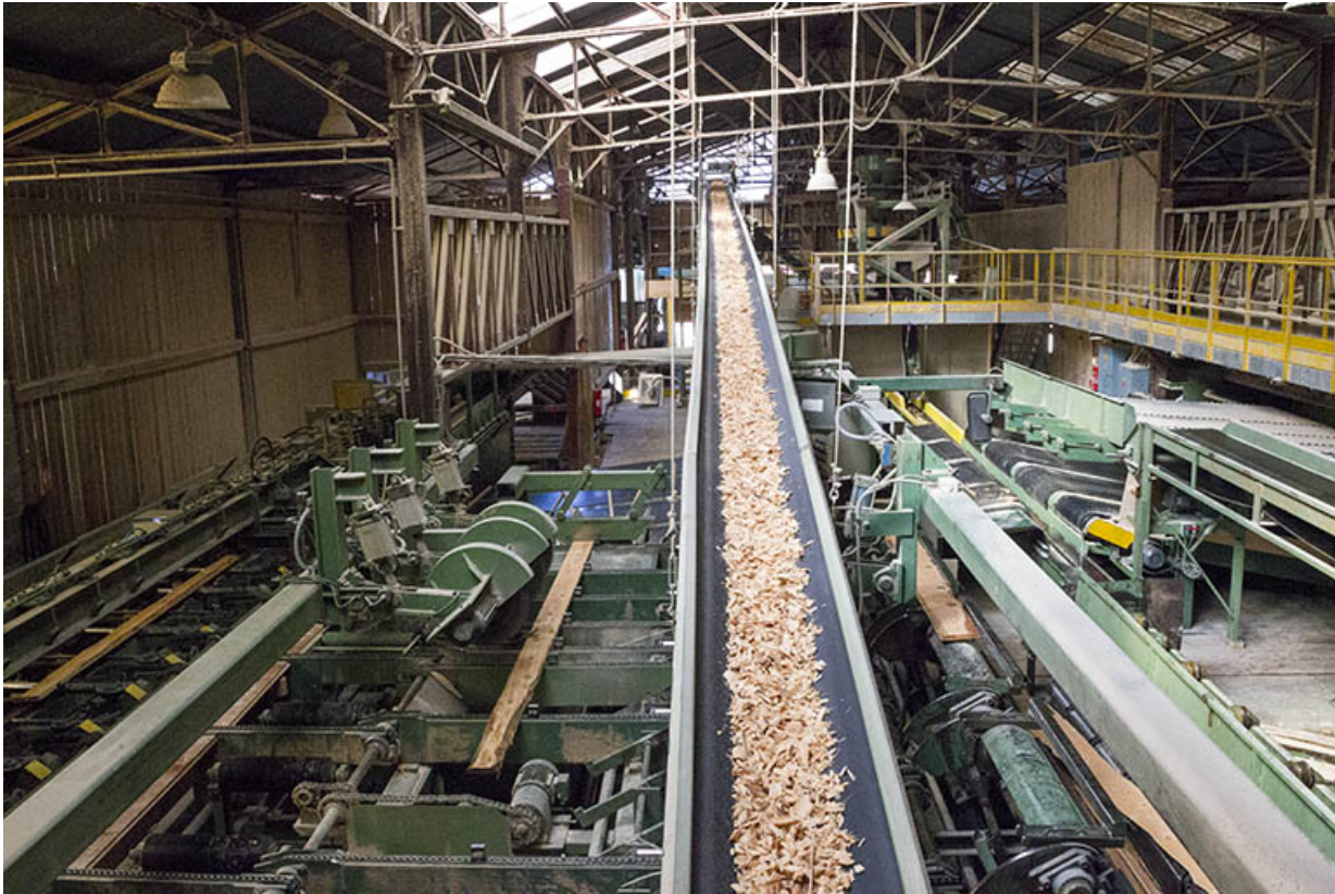
Ateliers de débitage (N et M) : machines de reprise et tapis roulant d'évacuation des sciures et des copeaux. 25, Maîche rue de la Scierie
