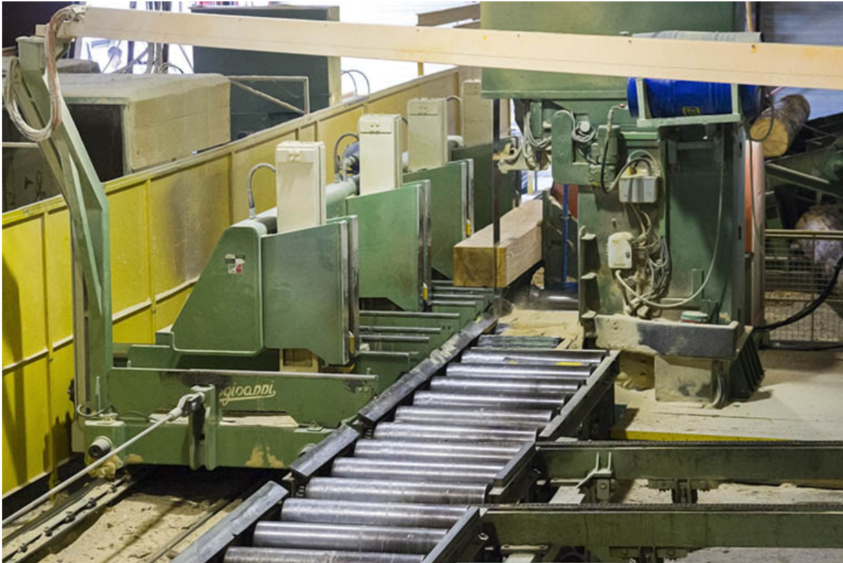
Atelier de débitage (N) : scie à ruban Bongioanni et son chariot, vus de l'aval. 25, Maîche rue de la Scierie
