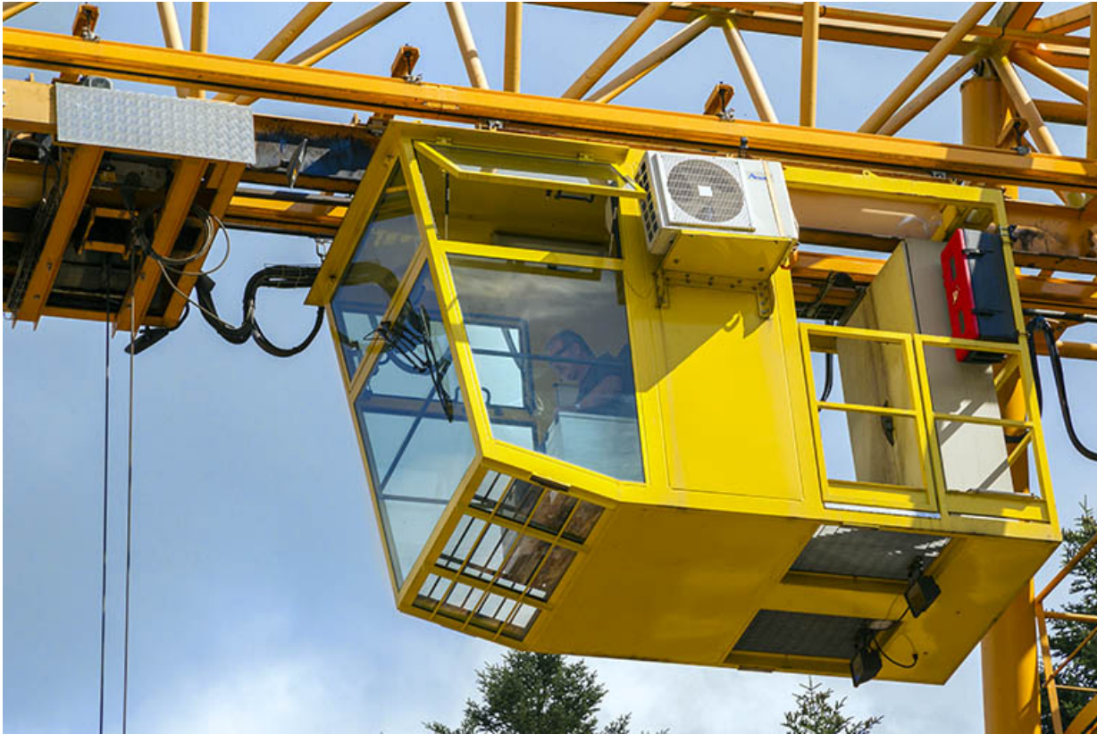
Portique roulant : cabine de commande.
