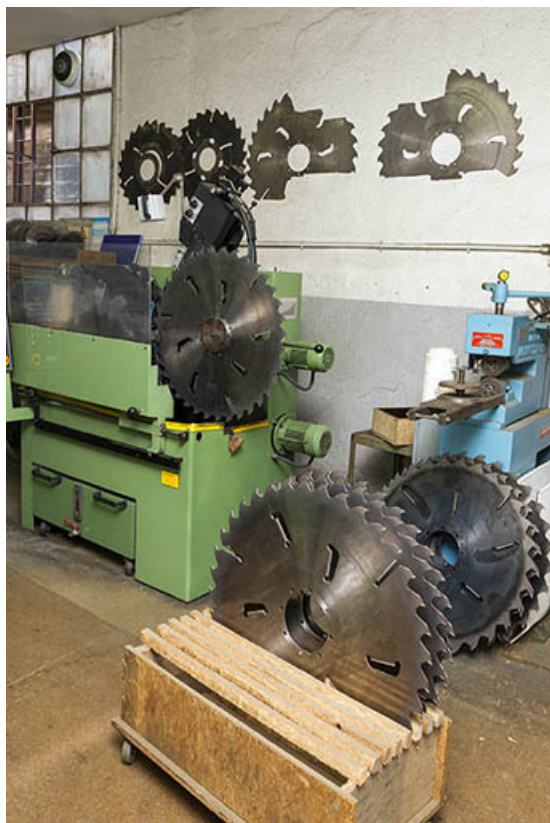
Atelier d'affûtage (K) : machine pour l'affûtage des lames de scie circulaire. 25, Maïche rue de la Scierie
