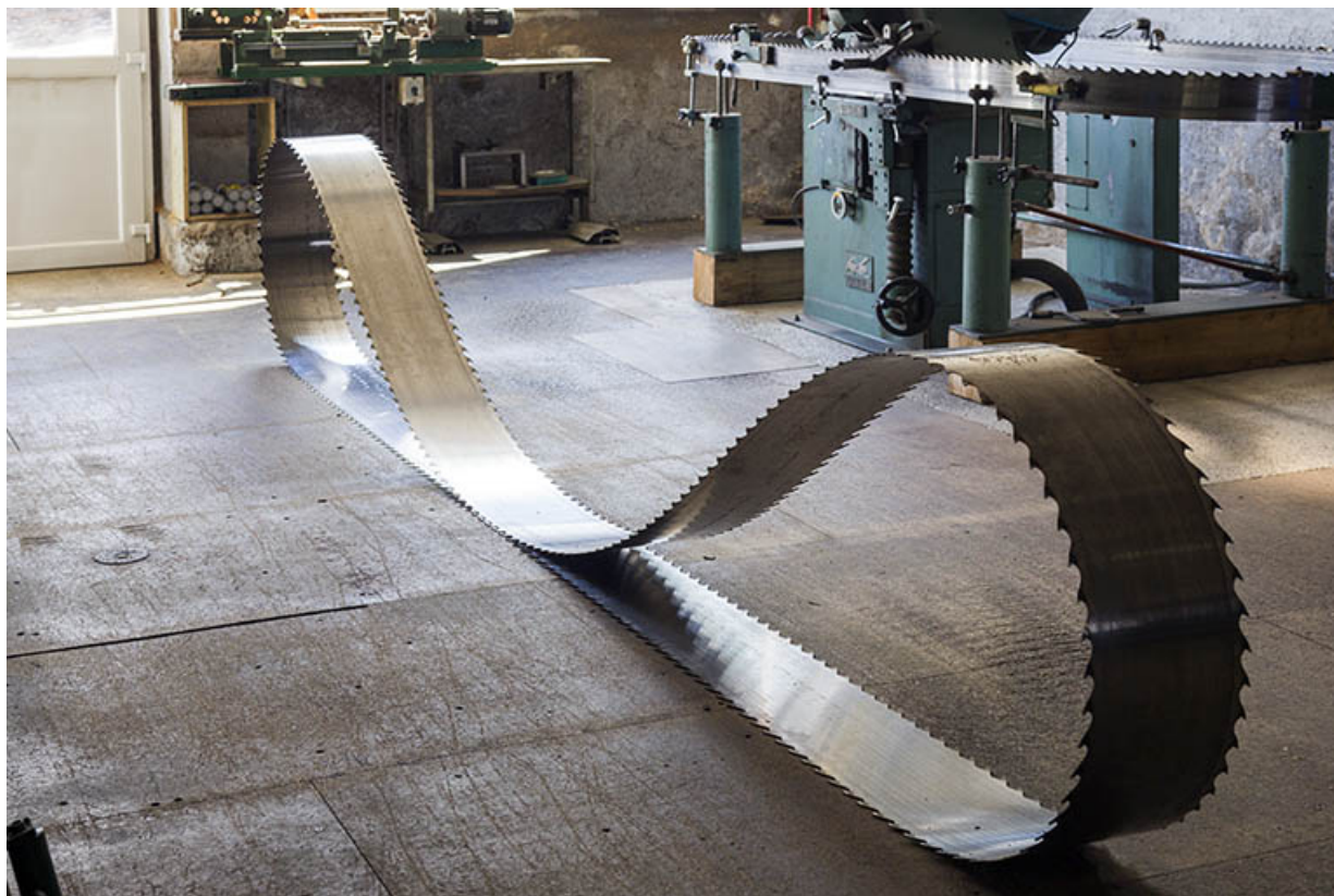
Atelier d'affûtage (K) : lame de scie à ruban à double denture. 25, Maïche rue de la Scierie
