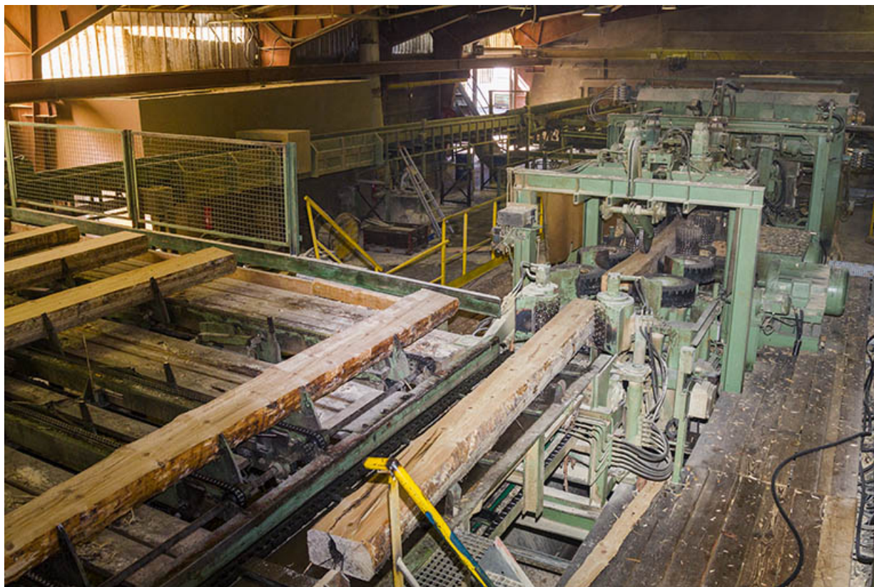
Atelier de débitage (N) : ligne "canter", pour les commandes destinées à la grande distribution.
