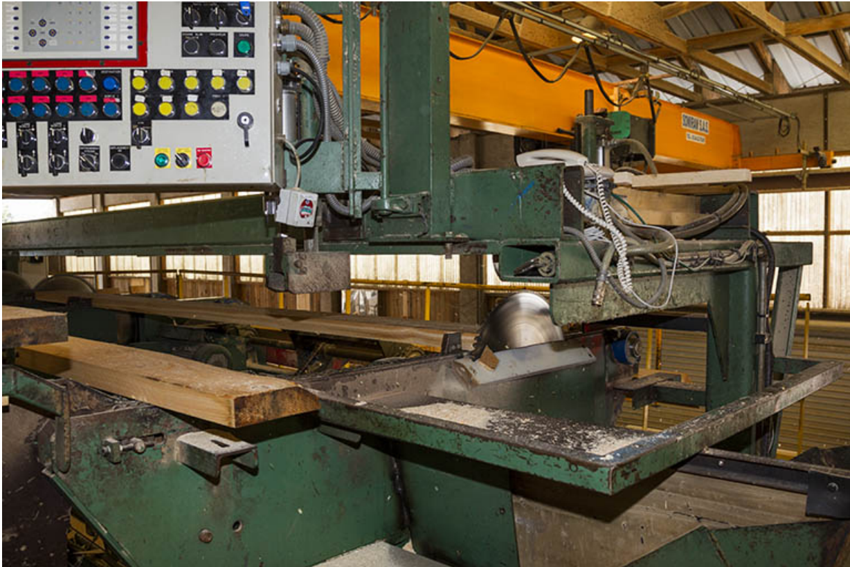
Atelier de triage et d'empilage (E) : scie circulaire de l'installation de sciage. 25, Maîche rue de la Scierie
