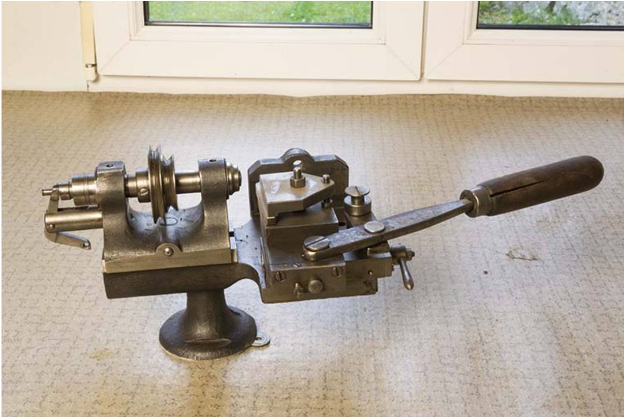
L'atelier (1912) d'un petit fabricant de machines pour les horlogers : Adelin Berçot puis Maurice Roch, au 13 rue Sous Monjoie. Machine à tamponner (insérer les tampons dans l'écorce du cylindre) des années 1910. 25, Maîche
