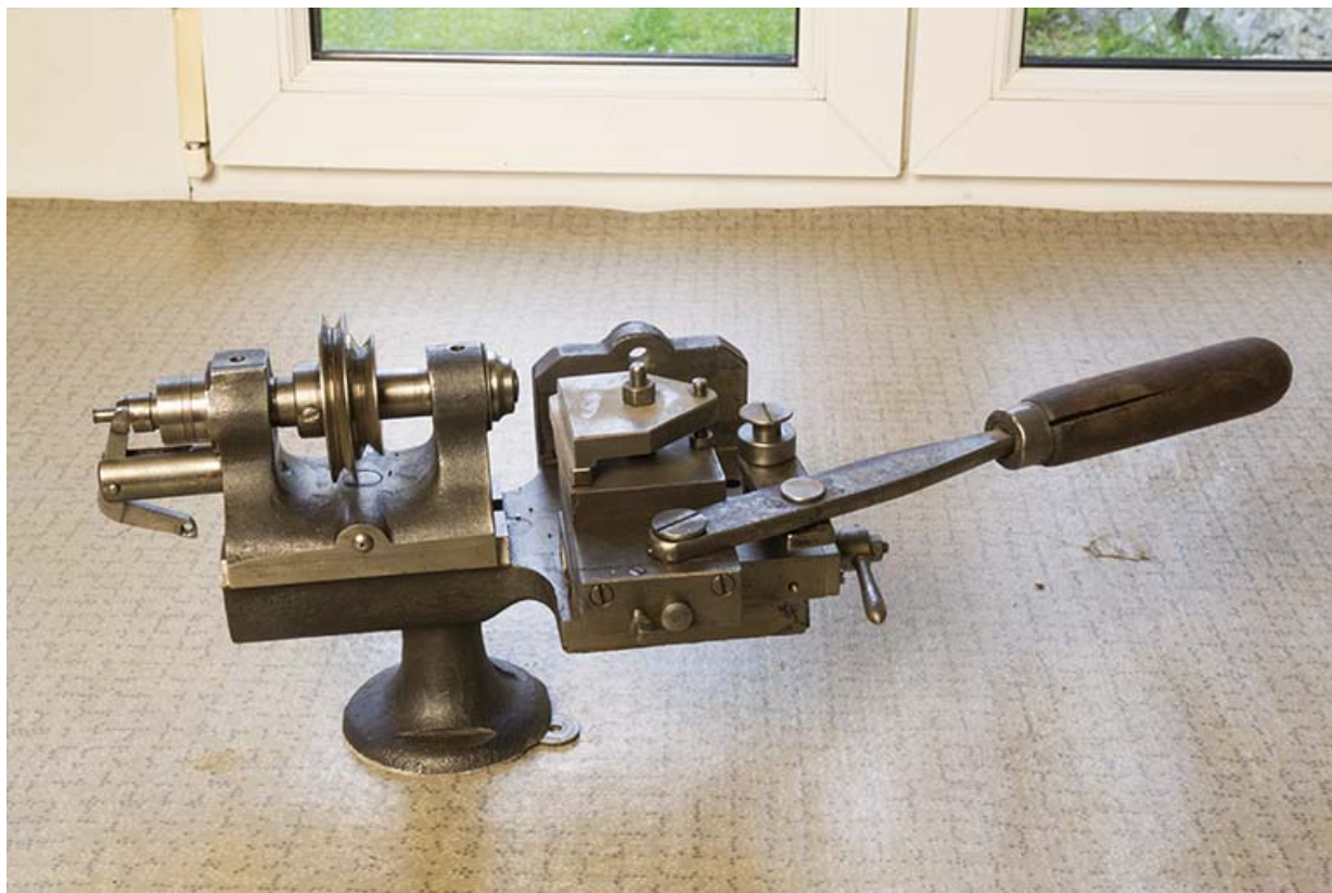
L'atelier (1912) d'un petit fabricant de machines pour les horlogers : Adelin Berçot puis Maurice Roch, au 13 rue Sous Monjoie. Machine à tamponner (insérer les tampons dans l'écorce du cylindre) des années 1910. 25, Maîche, 13 rue Sous Montjoie
