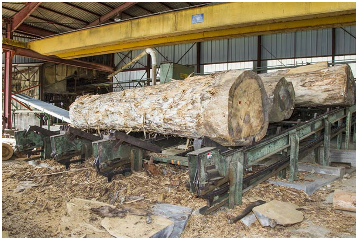
Atelier de fabrication de 1980-1982 : chariot à grumes alimentant la scie Gillet et Vigneau. 25, Cour-Saint-Maurice, 10 Rue Grande
