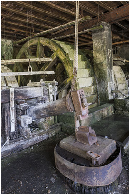
Le martinet est : le bras (ou manche) et la tête. Au sol : la chabotte et l'enclume.
