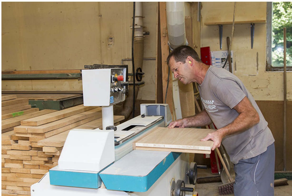
Atelier des années 1980 : ponceuse de chant Griggio.
