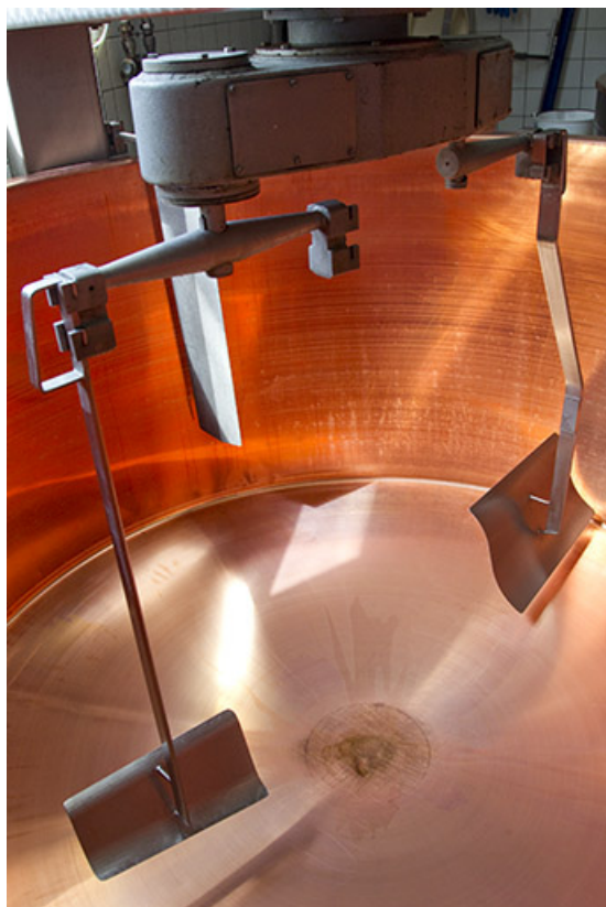
Cuve de fabrication : outils de brassage.
