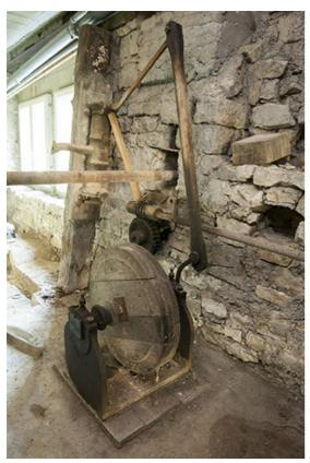
Système d'actionnement de la pompe à eau (bielle-manivelle). 25, Guillon-les-Bains, 4 rue de la Taillanderie
