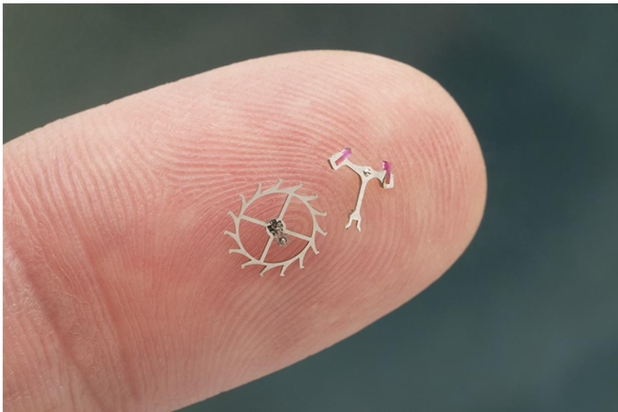
**L'échappement à ancre : de la micromécanique.**
