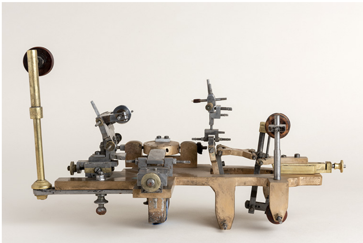
Machine à meuler et à limer (machine à passer les levées) de Léon Girardin, au Russey.
