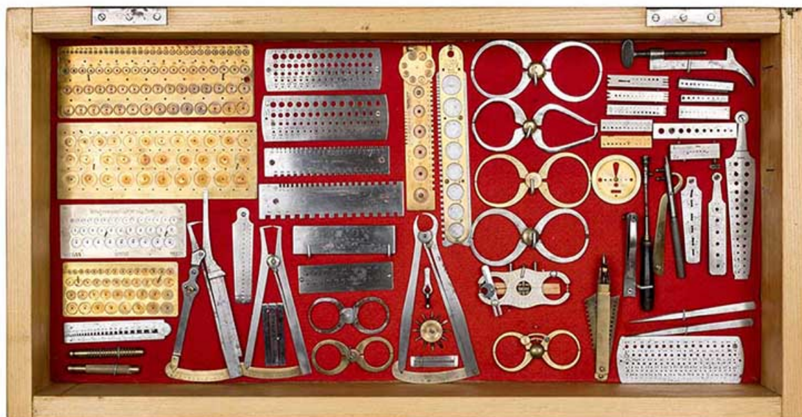
Outils produits dans la commune des Gras (calibres, filières, huit-chiffres, bancs à river, etc.). 25, Les Gras
