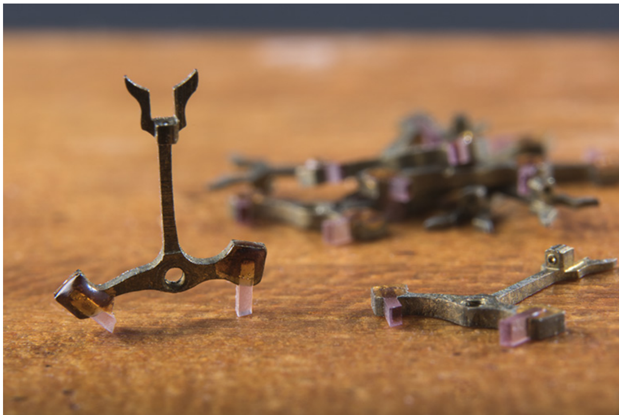
Ancre de montre (collection Jean-Claude Vuez, Villers-le-Lac). Celle placée verticalement repose sur ses deux palettes en rubis et présente sa fourchette en partie haute. Le paquet porte l'inscription : "10 fourchettes / 18" [...] / vis sans fin".
