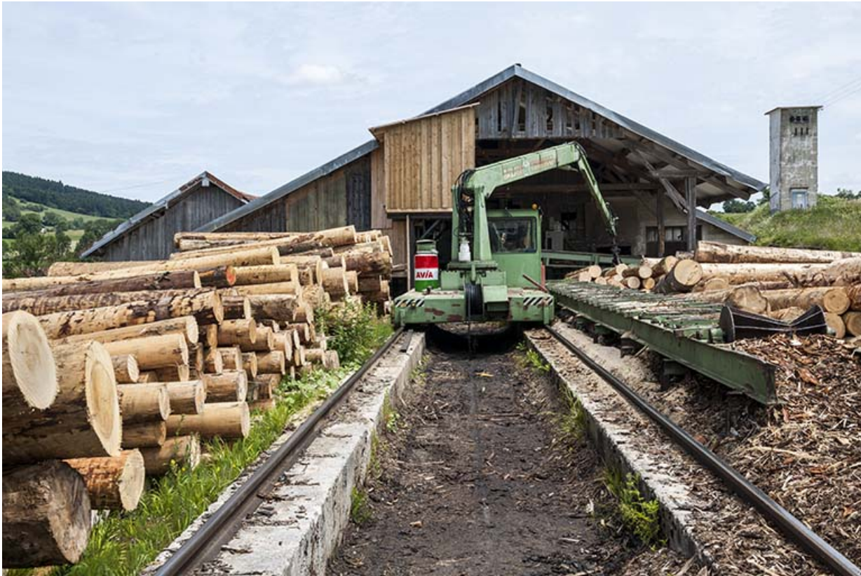
Chariot de transport de grumes, sur rails.
