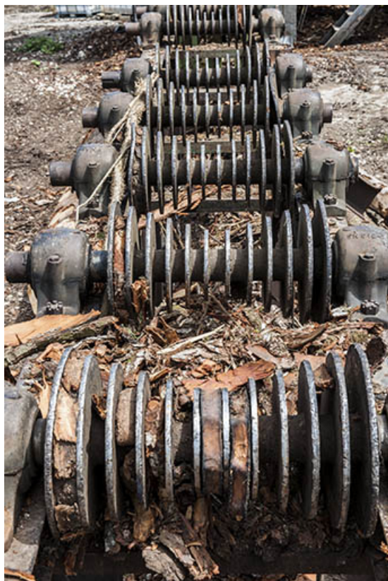
Détail des rouleaux d'entraînement.
