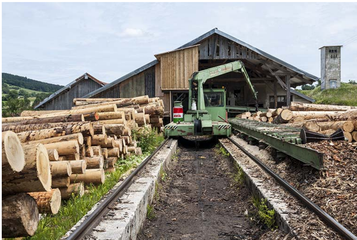
Chariot de transport de grumes, sur rails.
