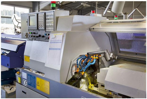
Machine à décolleter Star SR-10J type  ${\bf C}$  : commande et espace d'usinage.
