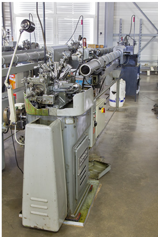
Machine à décolleter Tornos et son ravitailleur.
