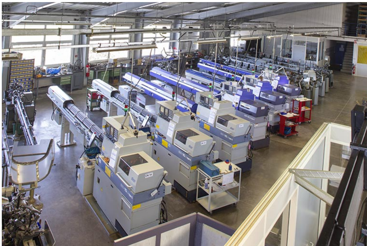
Machines à décolleter à commande numérique : usine de décolletage des Ets Perrenoud (rue Pierre Mendès-France), 25, Charquemont
