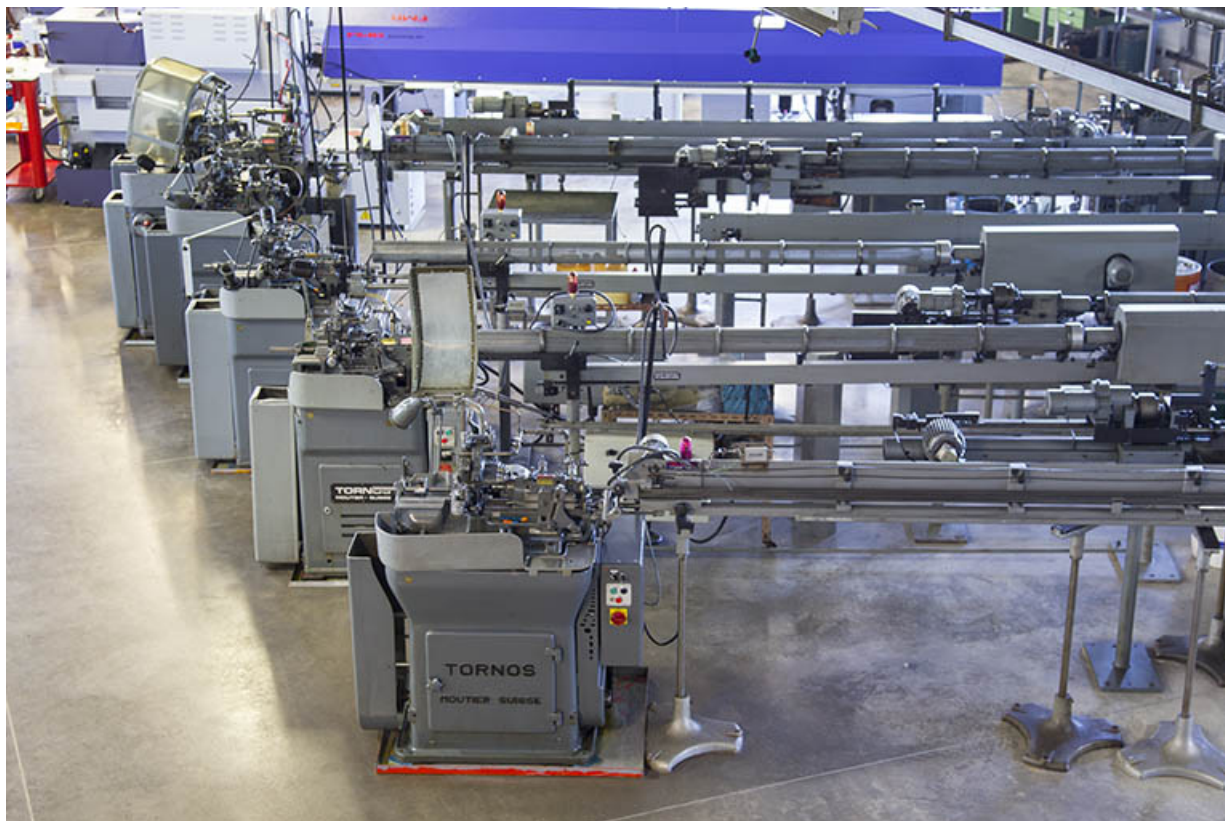
Machines à décolleter Tornos et leurs ravitailleurs (côté sud).
