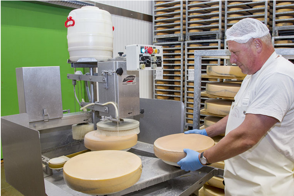
Affinage du morbier : frottage de la meule sous un filet de saumure.
