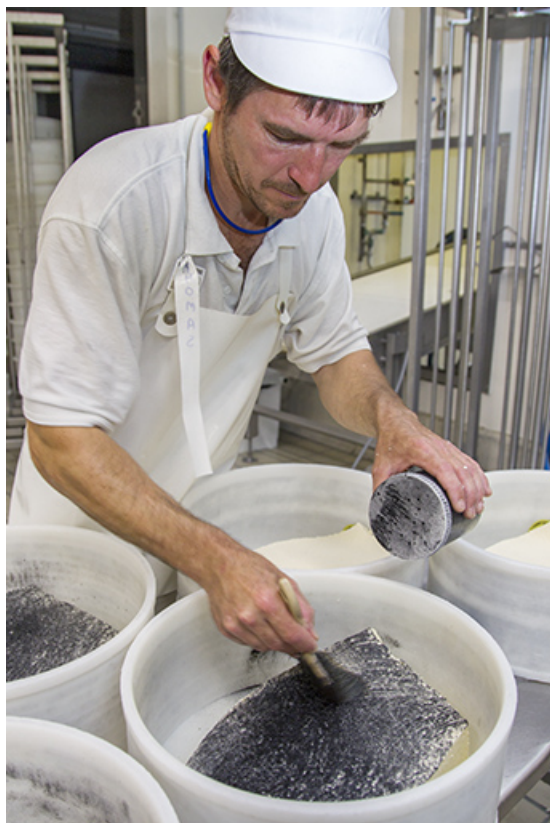
Fabrication du morbier : incorporation du charbon végétal.
