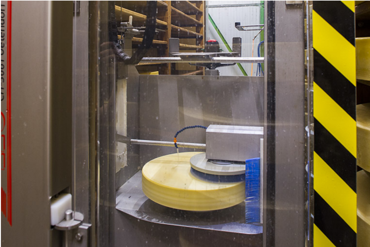
Affinage du comté : frottage de la meule sous un filet de saumure.
