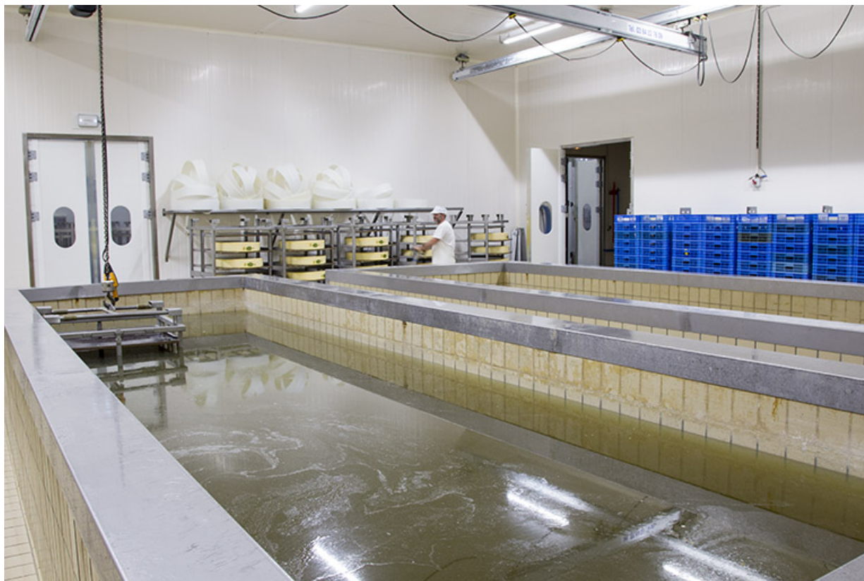
Fabrication : trempage des meules de comté dans le bac à saumure.
