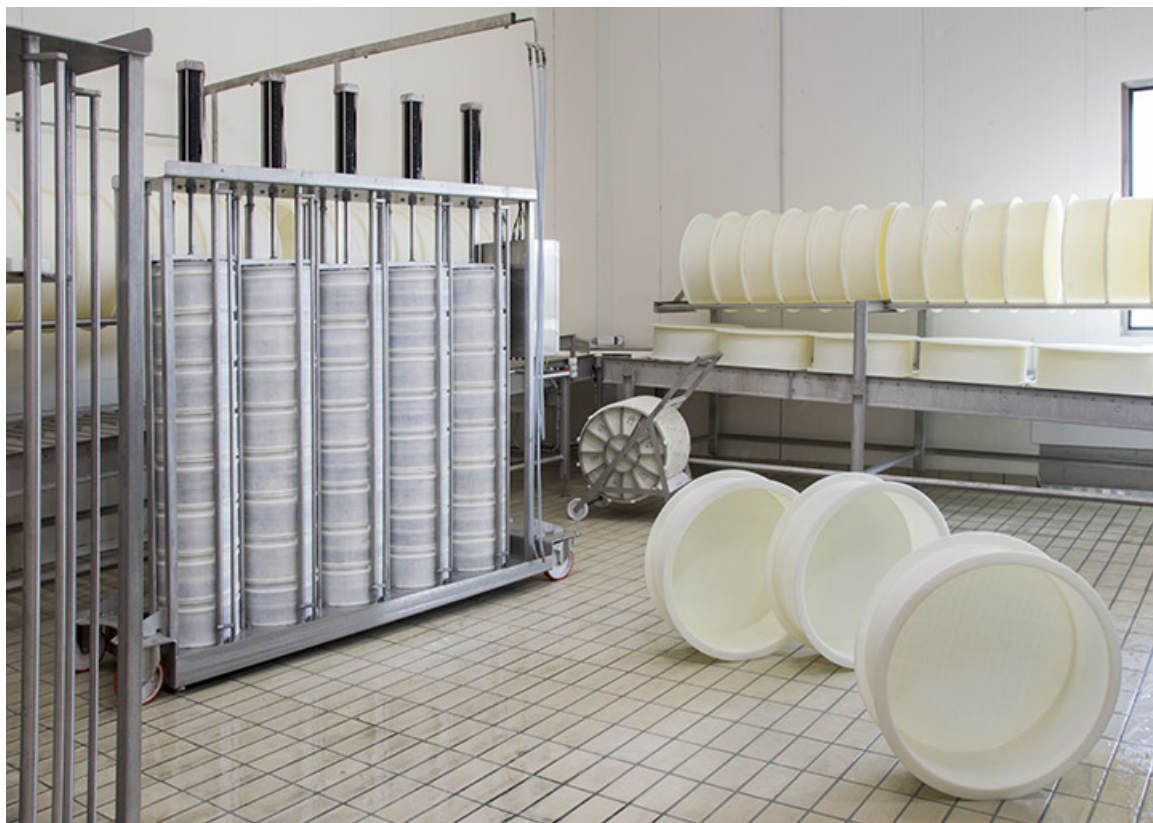
Atelier de fabrication : presses verticales à morbier et moule à comté.
