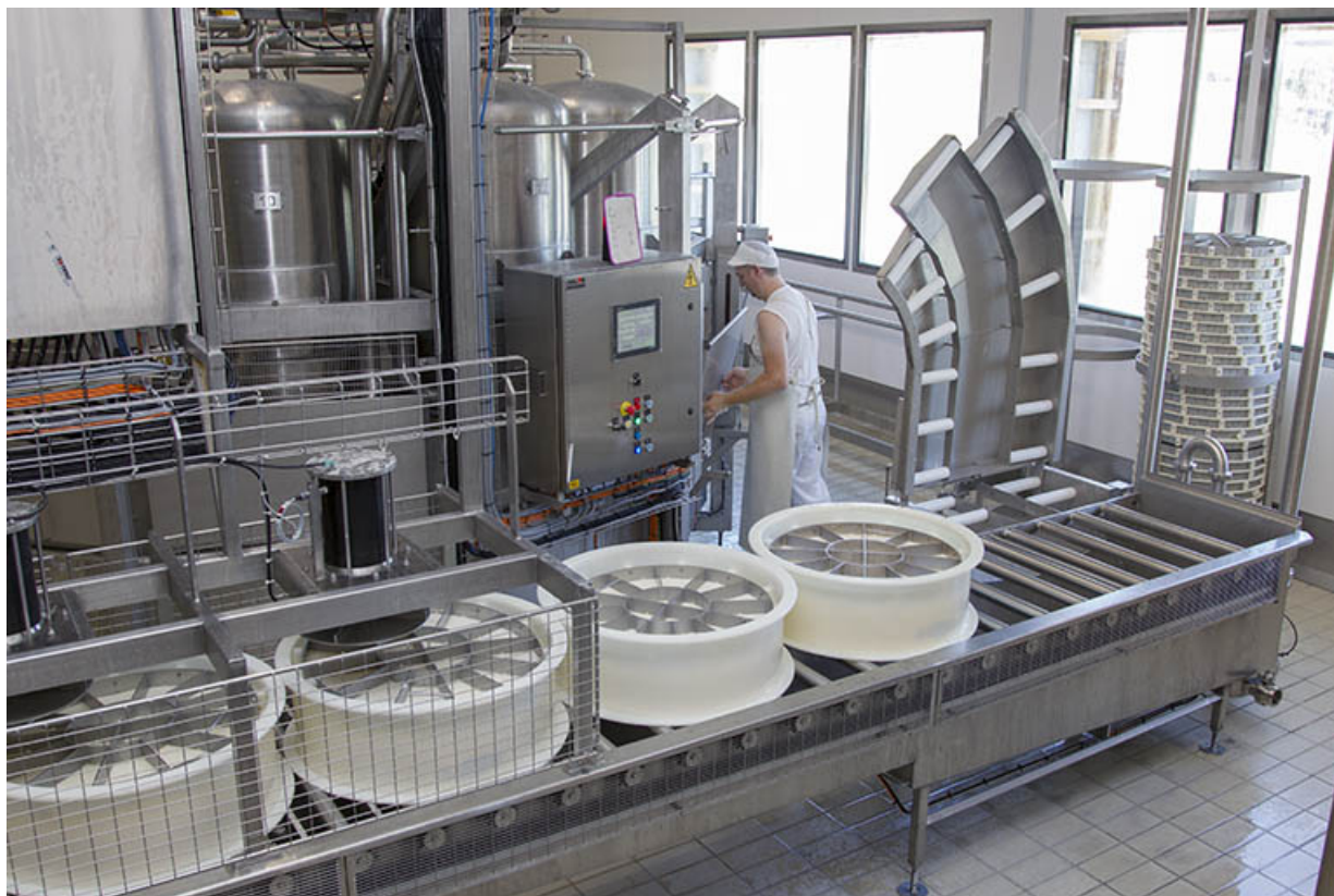
Fabrication : sortie du soutirage sous vide. 25, Charquemont, 6 rue Pierre Mendès-France
