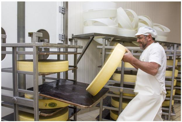
Fabrication : rognage des meules de comté à la sortie du bac à saumure.
