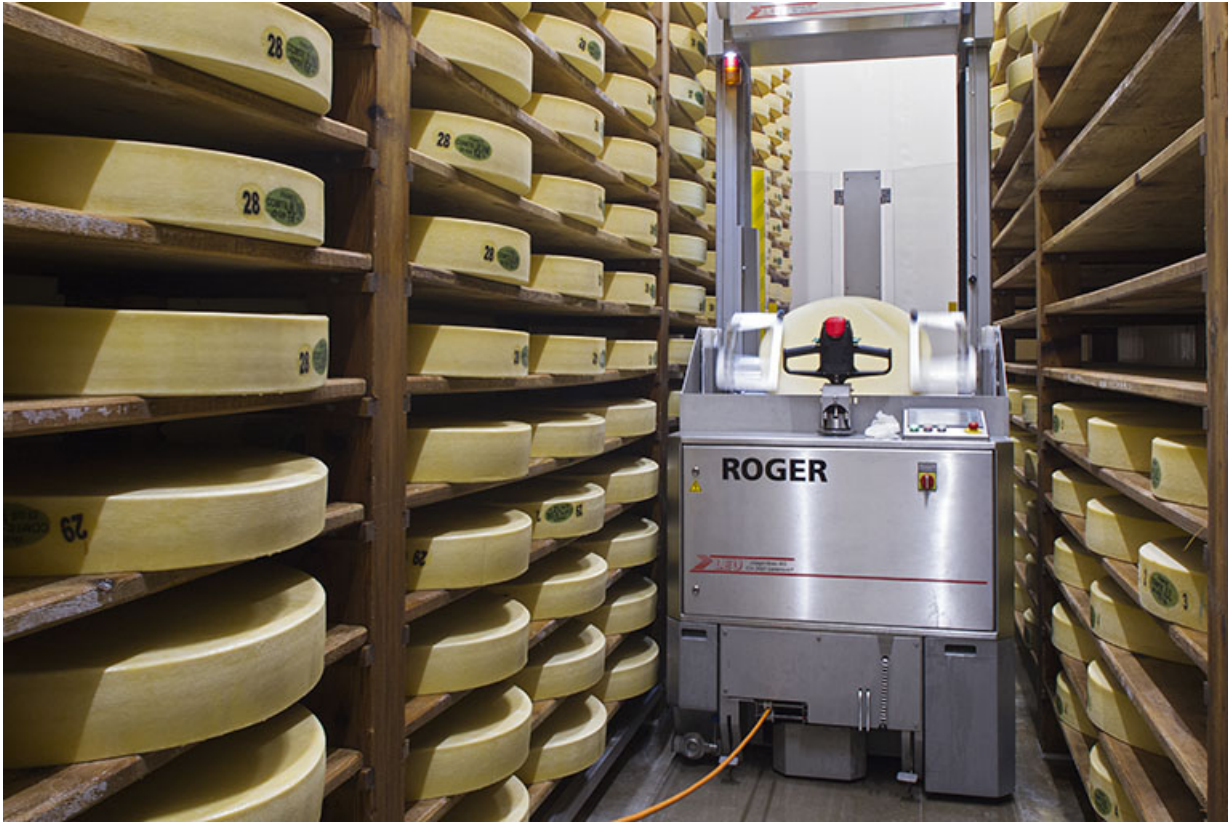
Affinage du comté : le robot de soins (vue rapprochée, avec retournement d'une meule).
