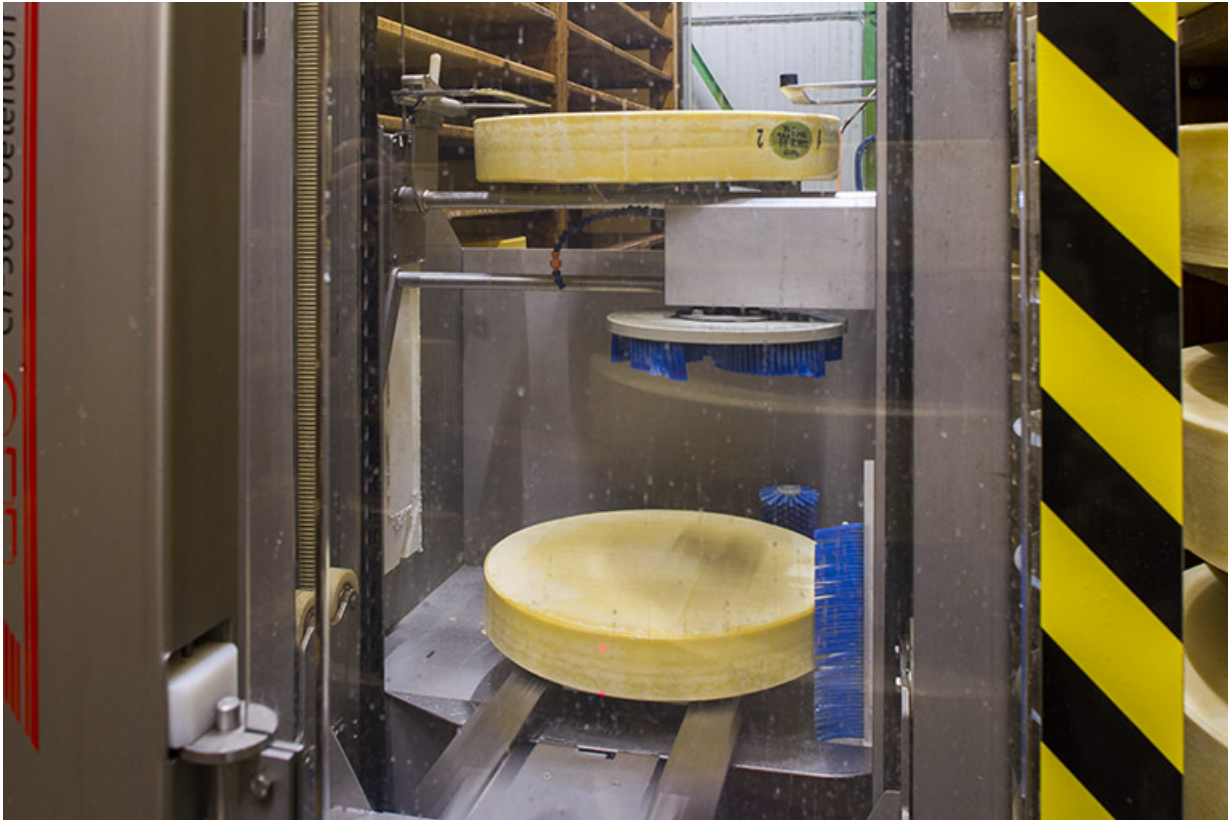
Affinage du comté : échange de meules dans le robot de soins.
