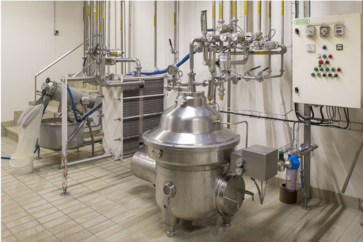
Salle de la station de lavage CIP : débourbeuse (à droite) et filtre à sérum. 25, Charquemont, 6 rue Pierre Mendès-France
