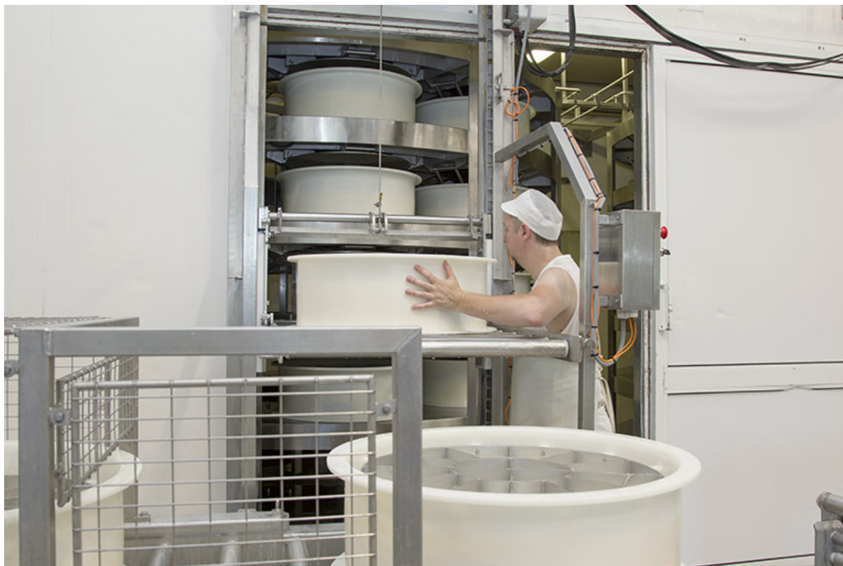
Fabrication : insertion d'un moule dans la presse tournante.
