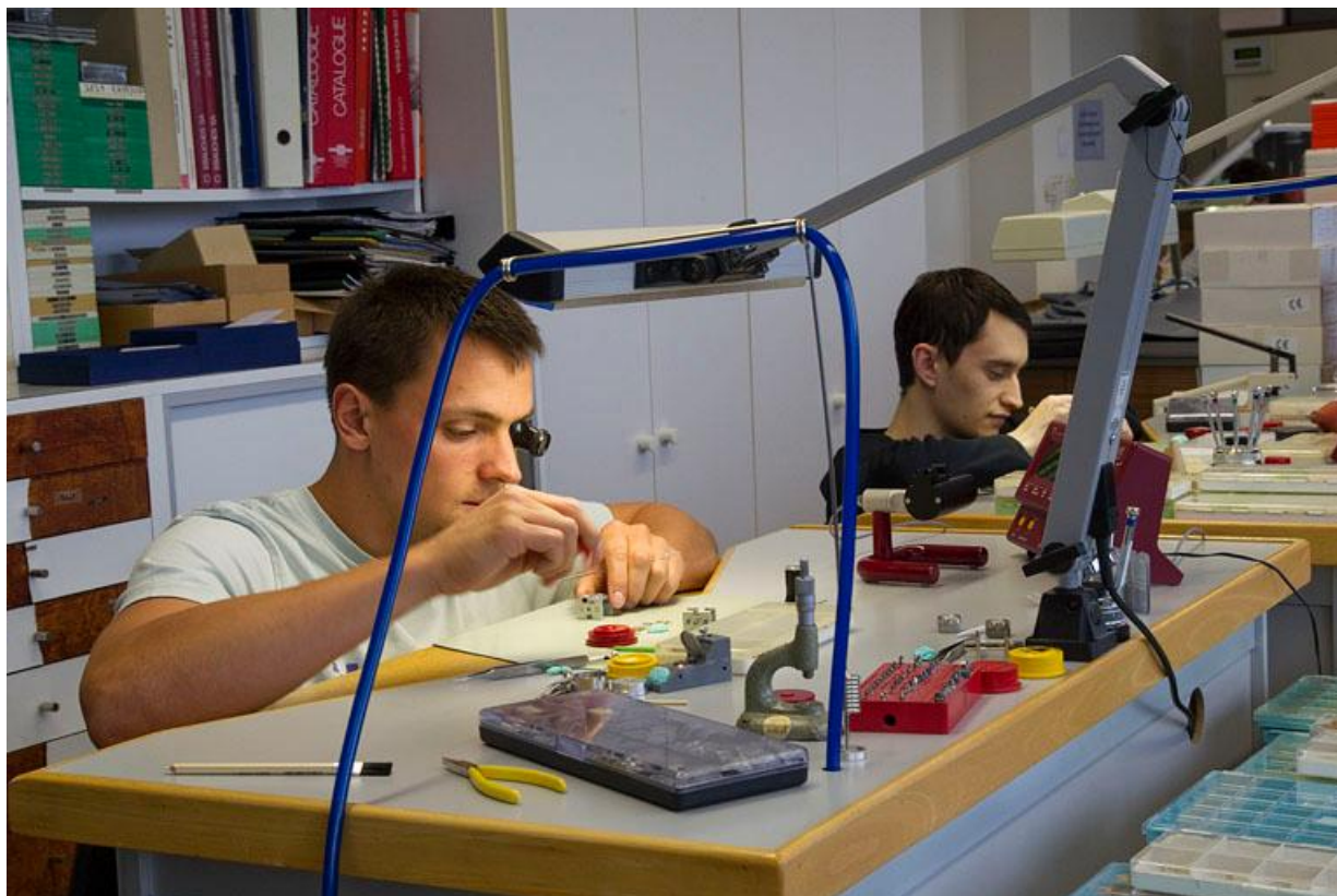
Atelier du service après-vente : réglage du mouvement.
