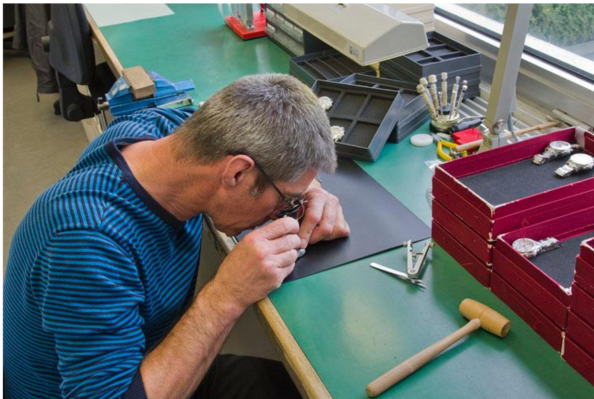
Atelier de fabrication : pose du bracelet. 25, Charquemont, 9 rue de la 1ère Armée
