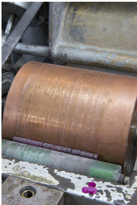
Atelier de taille du rubis : cylindre diamanté d'une machine. Les carrelats de rubis synthétique sont arrondis en frottant sur le cylindre.
