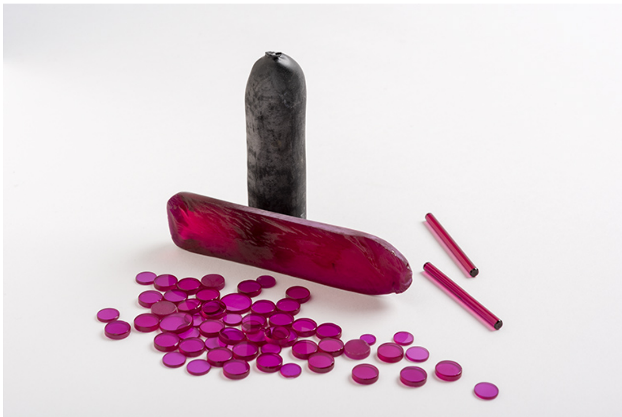
Boules (ou poires) de rubis synthétiques, baguettes et rondelles réalisées à l'usine Rubis-Précis, à Charquemont. 25, Charquemont, 18 rue de Besançon
