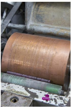
Atelier de taille du rubis : cylindre diamanté d'une machine. Les carrelets de rubis synthétique sont arrondis en frottant sur le cylindre.
