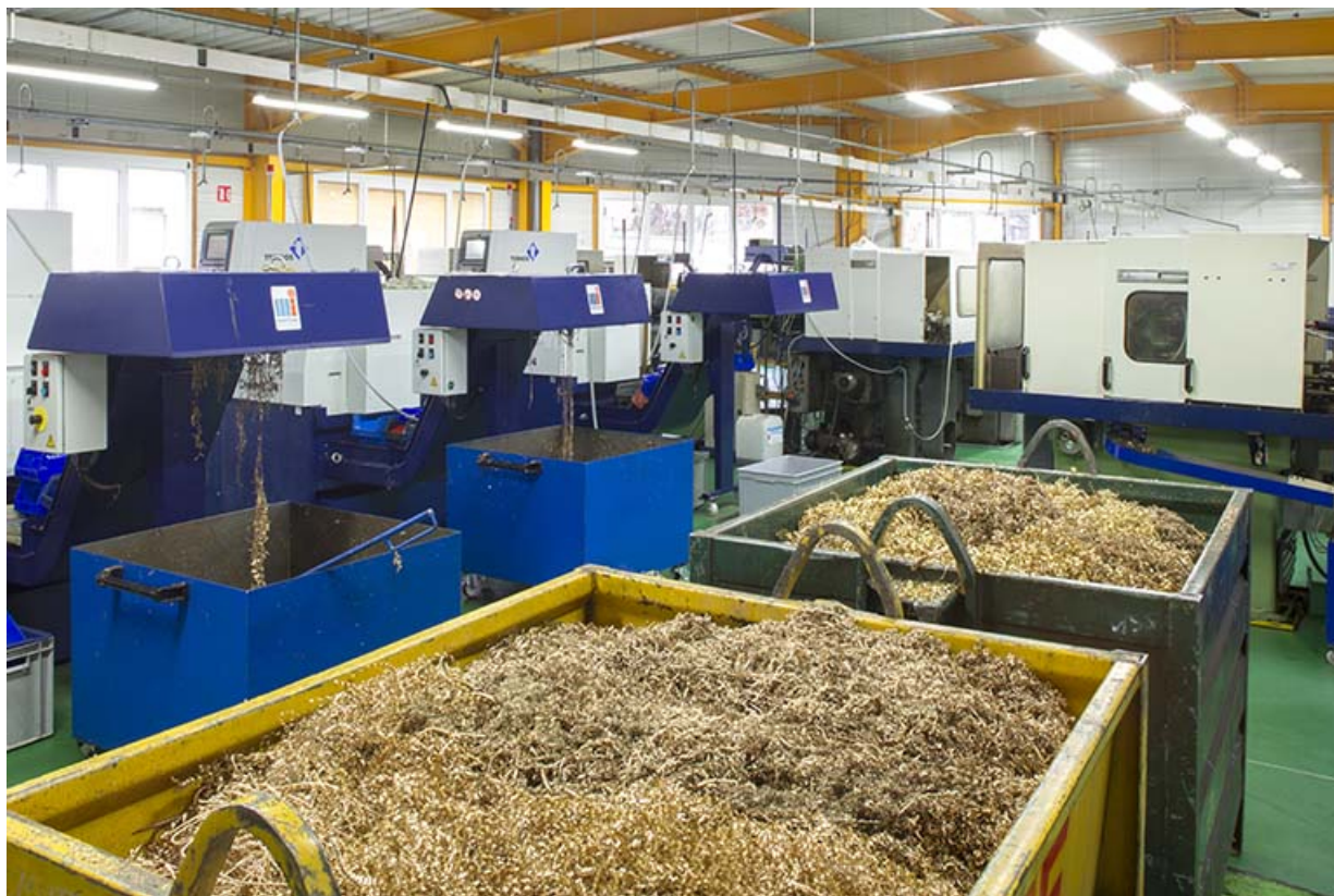
Bennes à copeaux de laiton, dans l'atelier de décolletage.
