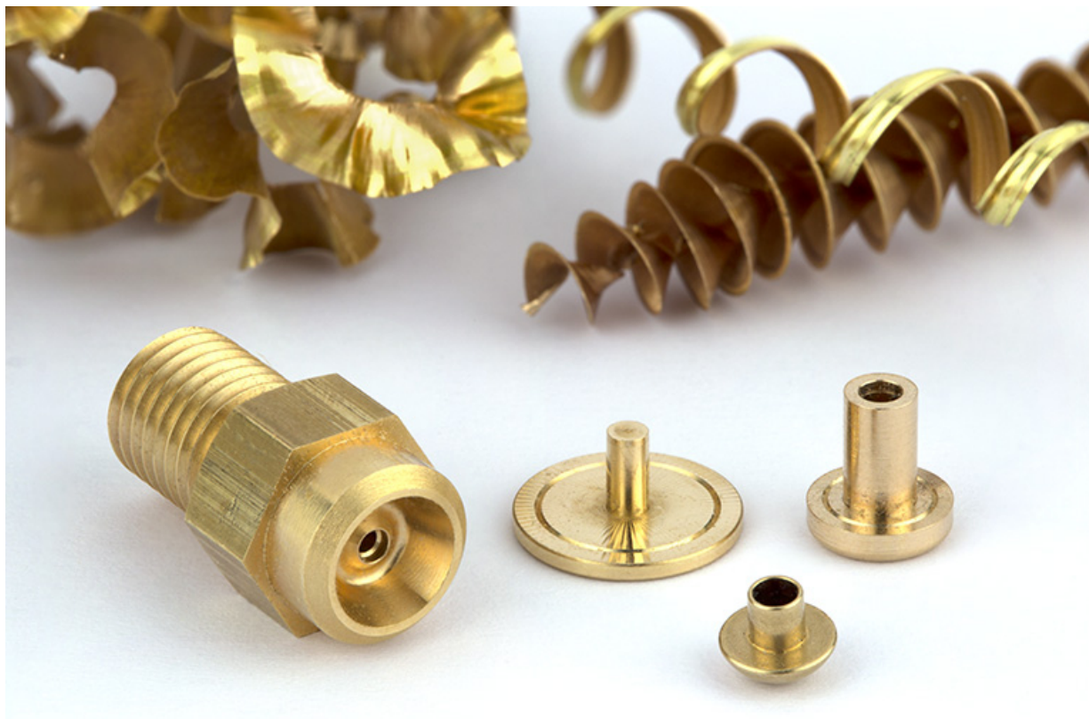
Pièces réalisées par décolletage. A gauche, un gicleur de chaudière (dépourvu de sa pastille en rubis). 25, Charquemont, 18 rue de Besançon
