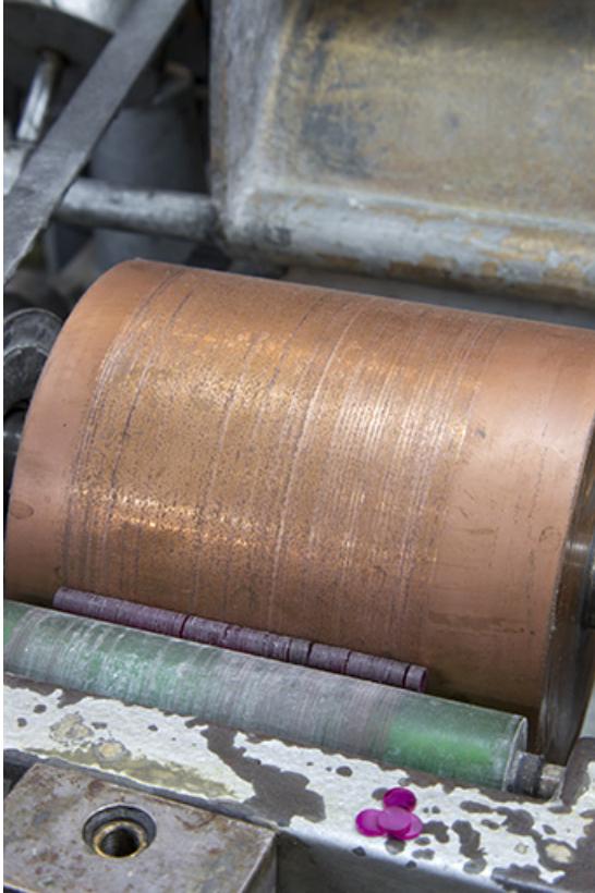
Atelier de taille du rubis : cylindre diamanté d'une machine. Les carreaux de rubis synthétique sont arrondis en frottant sur le cylindre.
