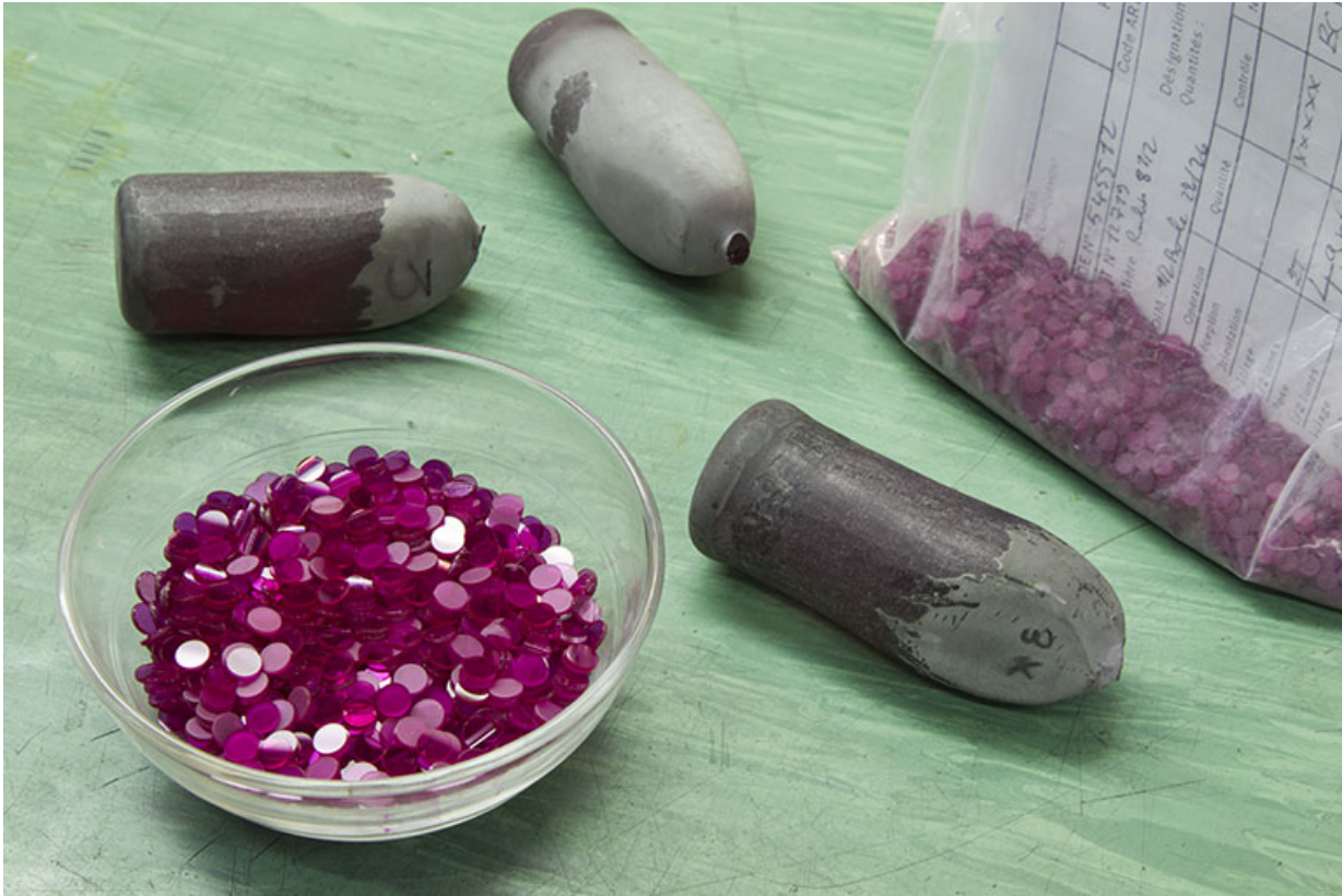
Boules (ou poires) de rubis synthétiques et rondelles réalisées à l'atelier : usine de taille de pierres pour l'horlogerie, de décolletage et de polissage Rubis-Précis (18 rue de Besançon). 25, Charquemont
