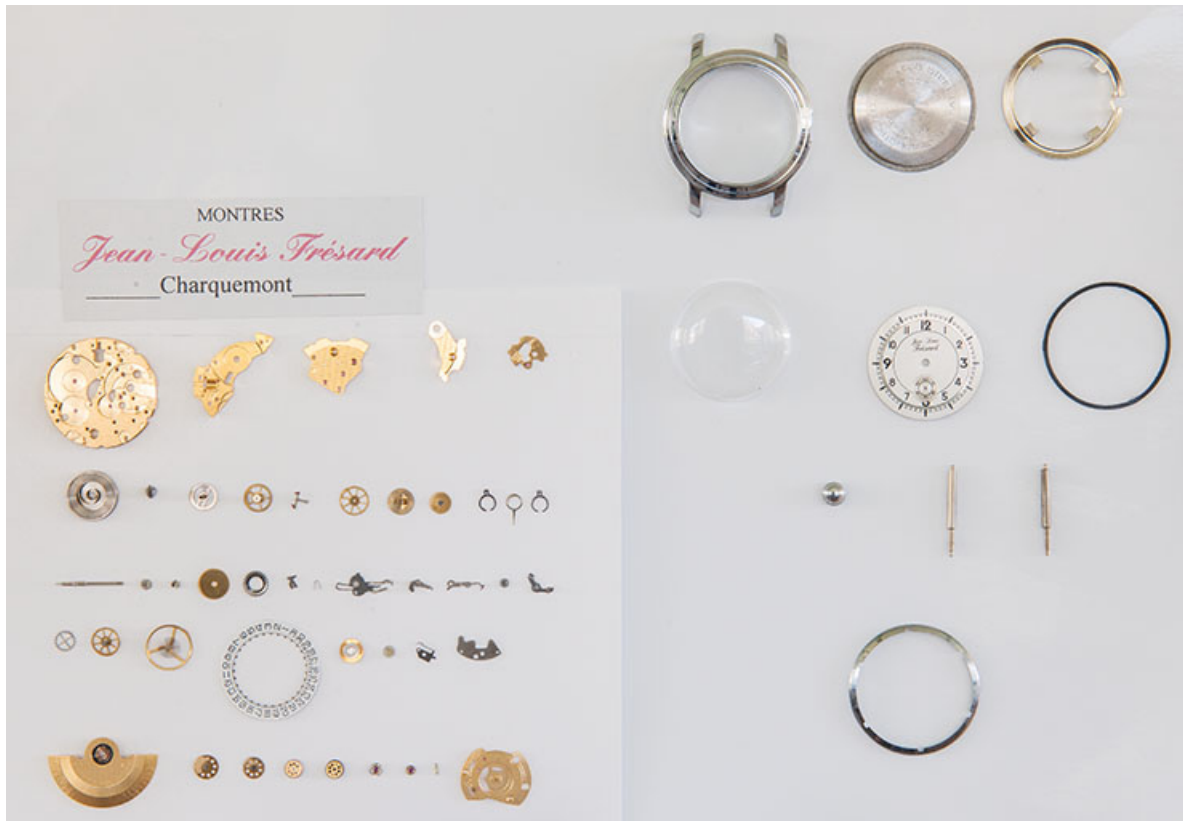
Pièces constitutives d'une montre mécanique. 25, Charquemont, 13 rue Jean Moulin
