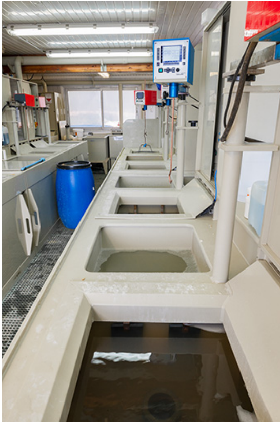
Usine : atelier de galvanoplastie (installations à l'arrière de la façade latérale gauche). 25, Frambouhans, 4 rue de la Velle
