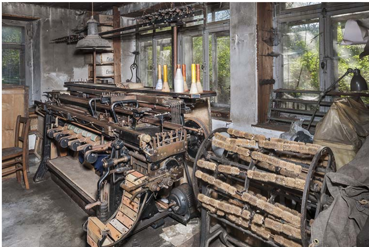
Machine à tricoter à plat (métier à mailles retournées Stoll & C°, à gauche) et machine à carder rotative (à droite). 25, Frambouhans, 2 rue de la Bonneterie
