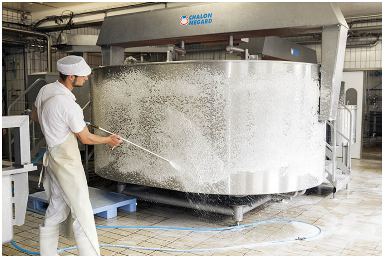
Nettoyage des installations : extérieur d'une cuve de fabrication.
