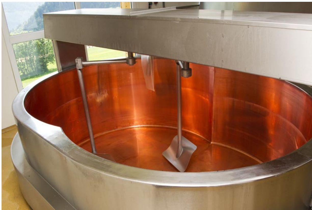
Cuve de fabrication : vue plongeante montrant l'intérieur.
