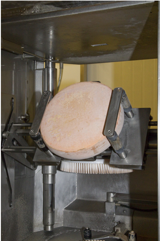
Fabrication du morbier : retournement d'une meule (robot).
