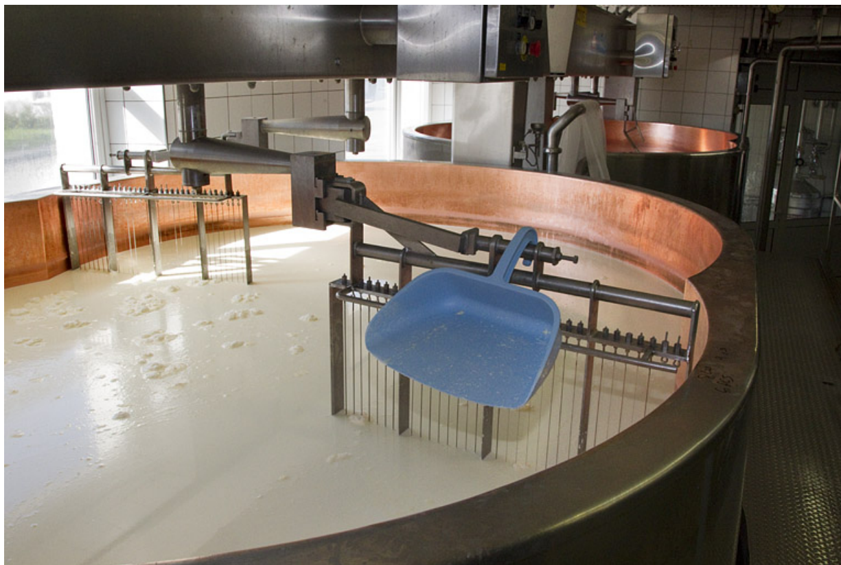
Fabrication du comté : deuxième cuve, avec tranche-caillé et pelle. 25, Damprichard, 20 rue des Ecoles
