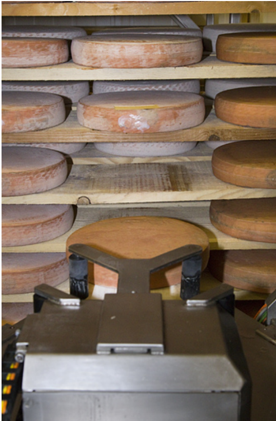
Fabrication du morbier : système de préhension des meules (robot).
