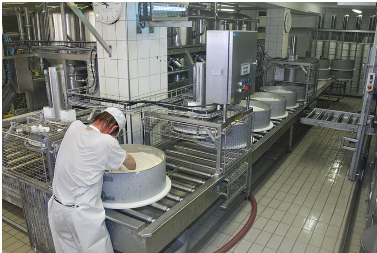
Fabrication du comté : enlèvement de l'écume du moule rempli de caillé et mise en place de la plaque de caséine. 25, Damprichard, 20 rue des Ecoles
