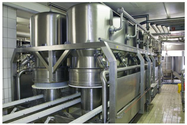
Fabrication du comté : installation de soutirage (face arrière).
