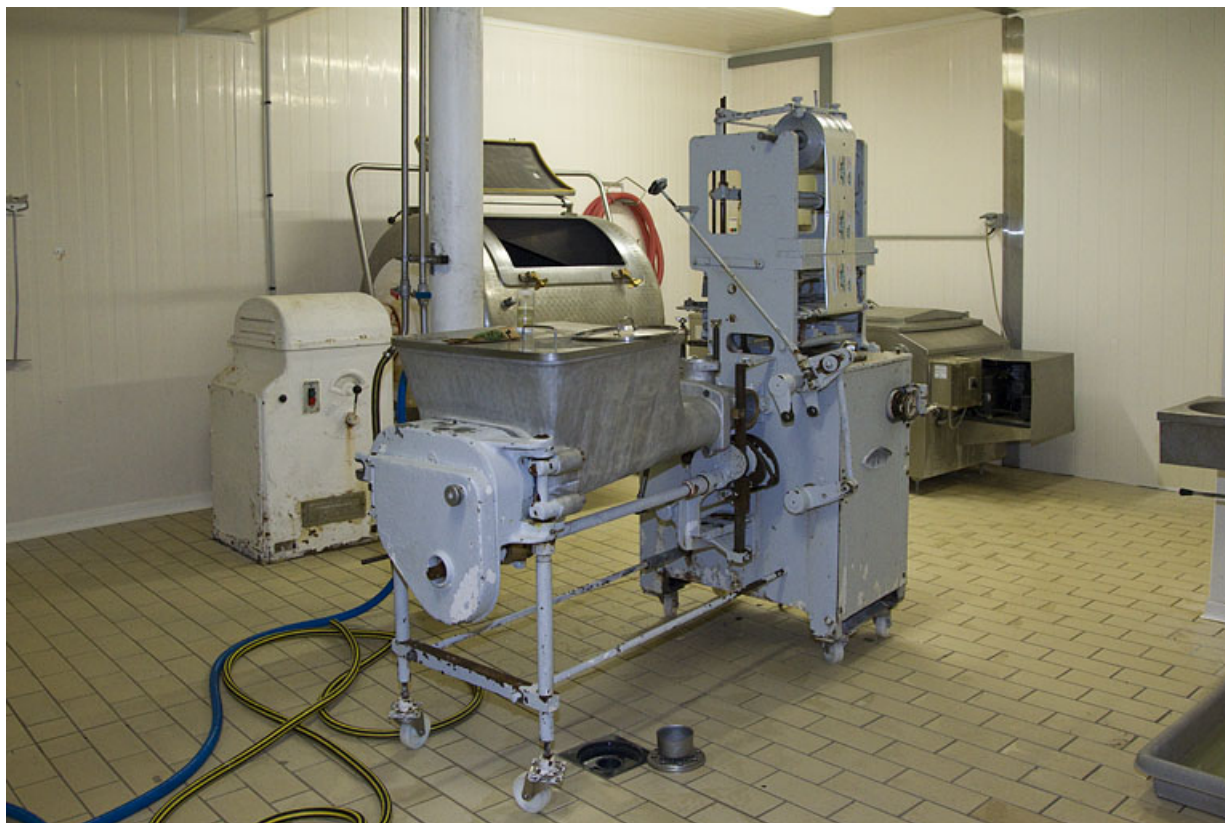
Fabrication du beurre : la mouleuse-empaqueteuse.
