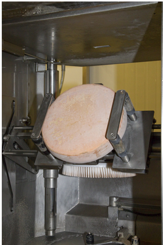
Fabrication du morbier : retournement d'une meule (robot).
