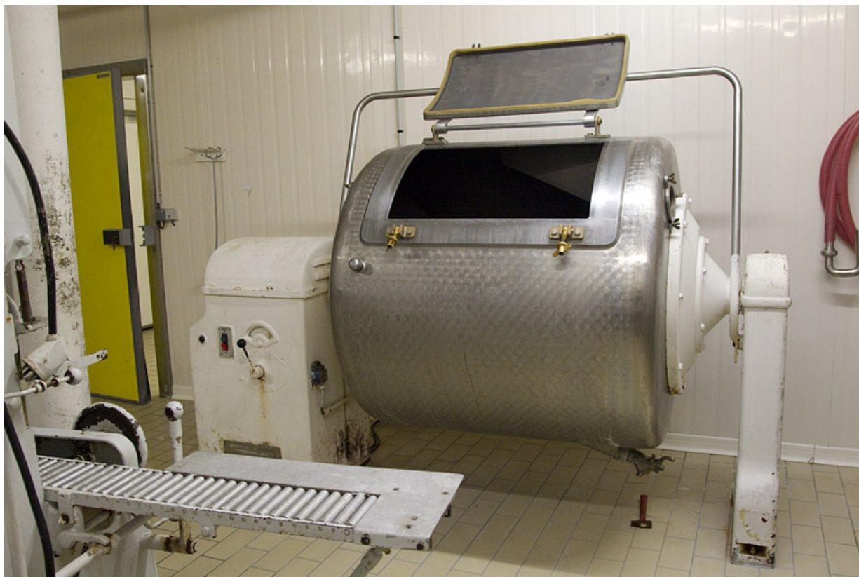
Fabrication du beurre : la baratte. 25, Damprichard, 20 rue des Ecoles
