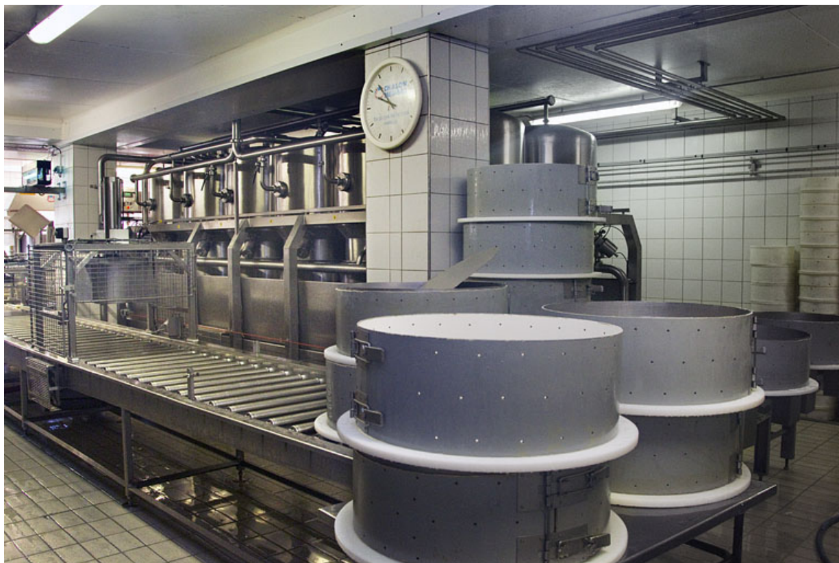
Fabrication du comté : installation de soutirage, moules et transporteur à rouleaux.
