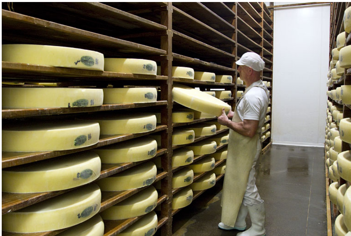
Fabrication du comté : retournement manuel d'une meule en cave d'affinage.
