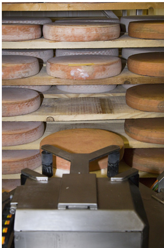
Fabrication du morbier : système de préhension des meules (robot). 25, Damprichard, 20 rue des Ecoles
