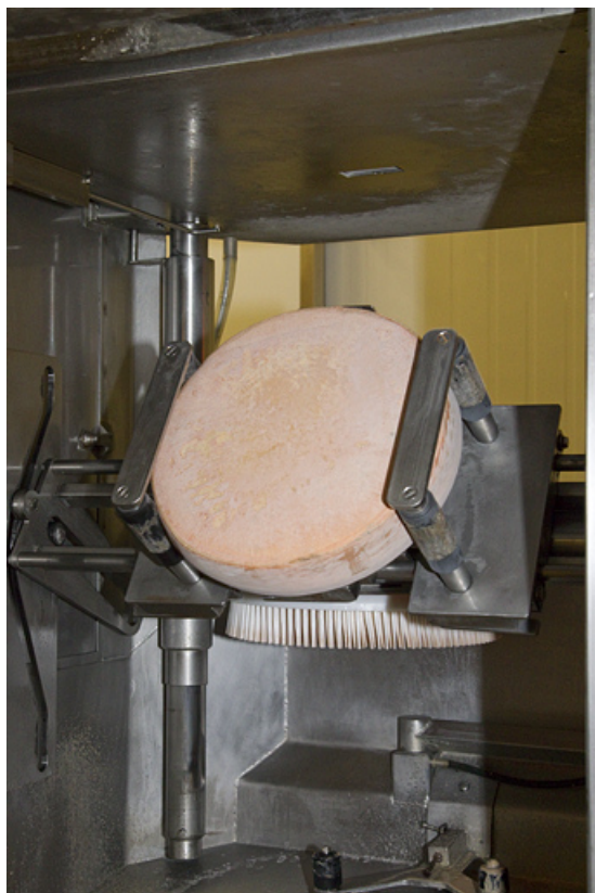
Fabrication du morbier : retournement d'une meule (robot).
