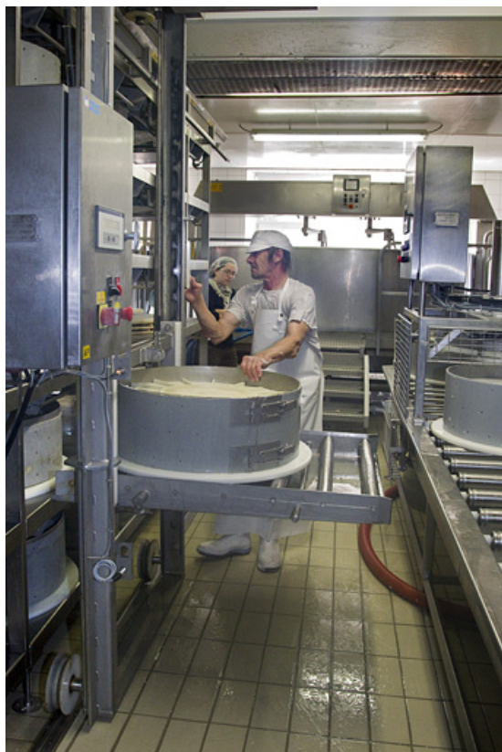
Fabrication du comté : mise sous presse du moule rempli de caillé. 25, Damprichard, 20 rue des Ecoles
