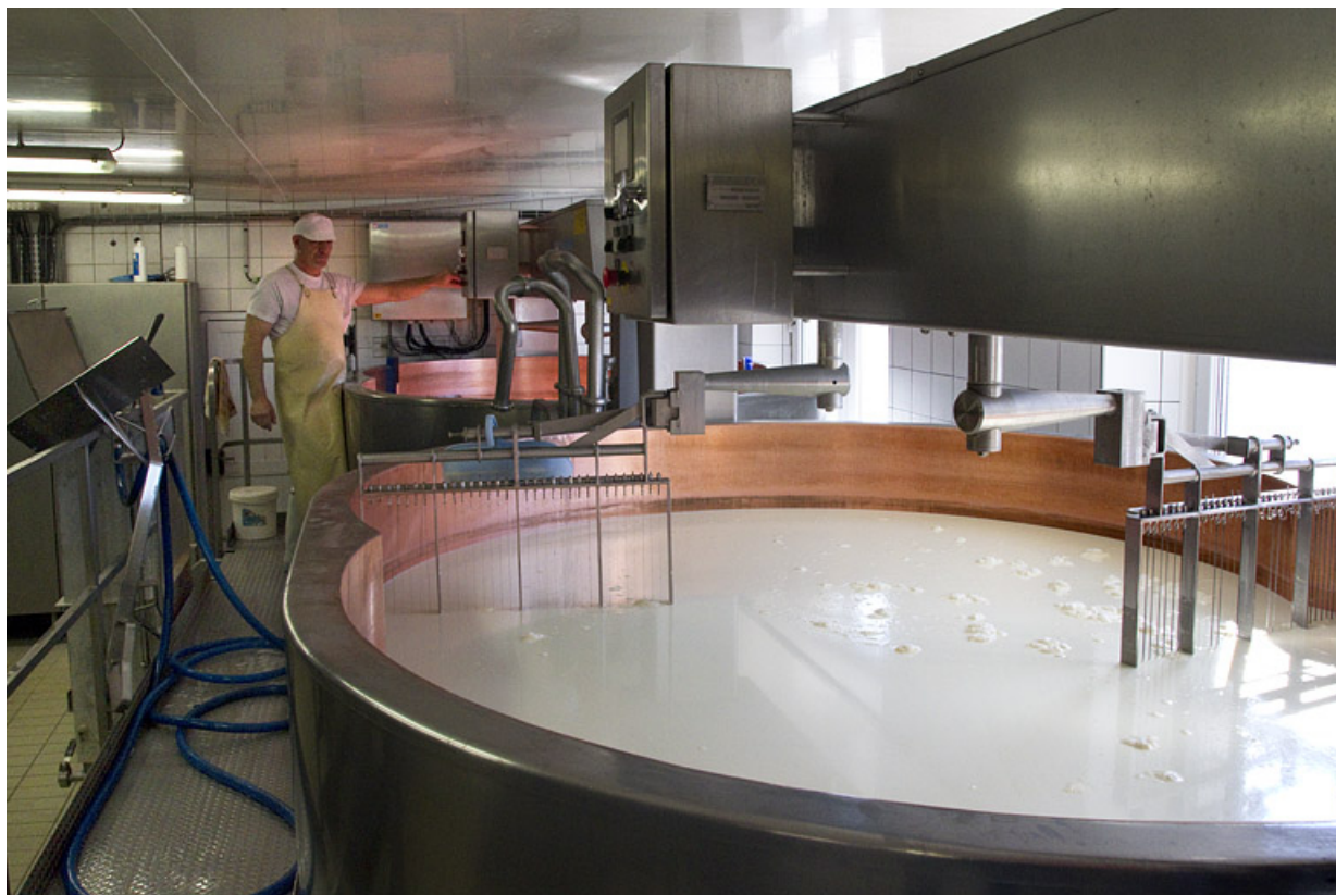
Fabrication du comté : deuxième cuve.
