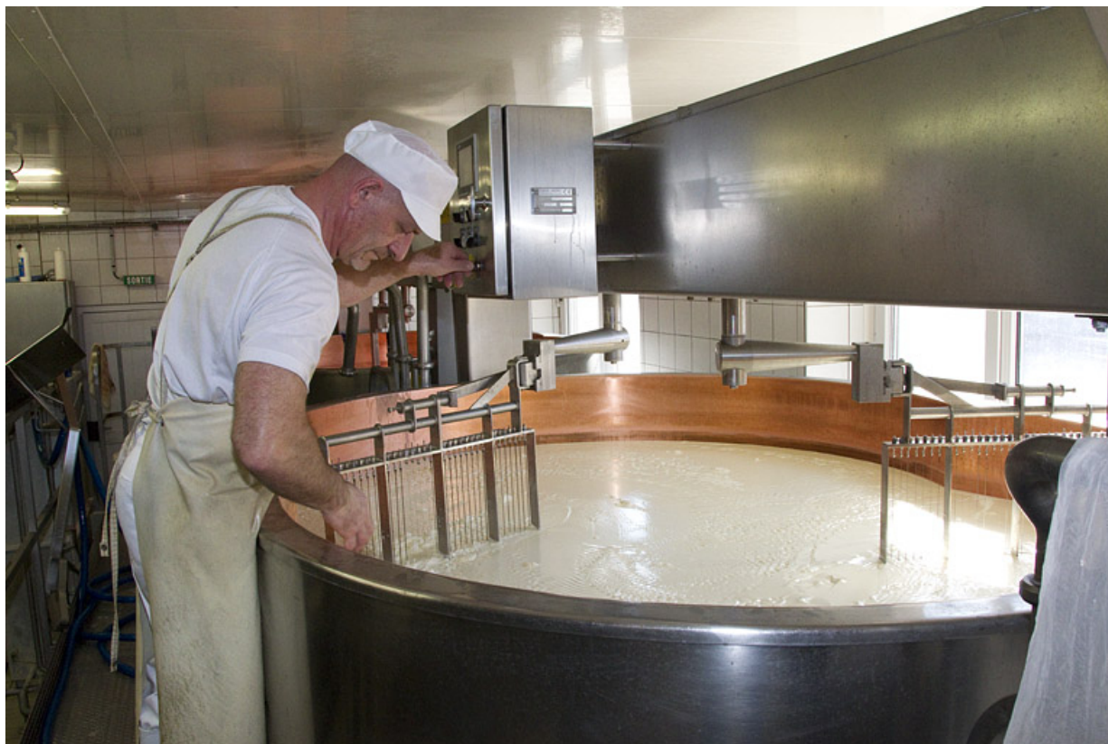
Fabrication du comté : examen du tranchage du caillé dans la deuxième cuve. 25, Damprichard, 20 rue des Ecoles
