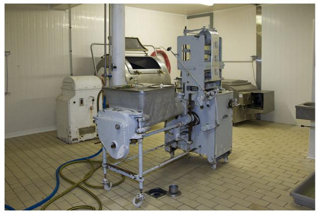
Fabrication du beurre : la moulureuse-empaqueteuse.
