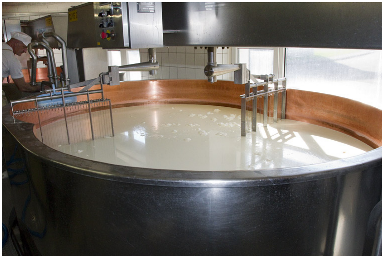
Fabrication du comté : deuxième cuve, équipée des tranche-caillé. 25, Damprichard, 20 rue des Ecoles
