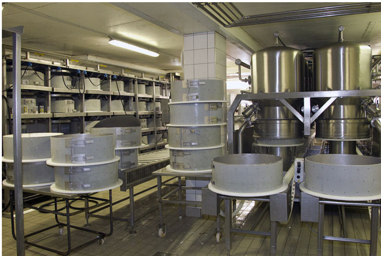
Fabrication du comté : installation de soutirage et moules.
