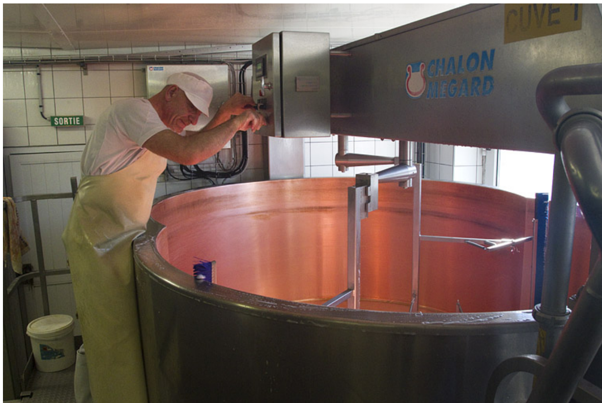
Fabrication du comté : nettoyage de la première cuve (réglage des brosses) 25, Damprichard, 20 rue des Ecoles
