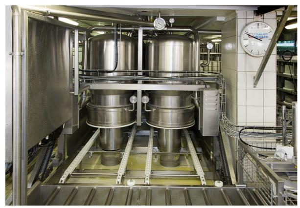
Fabrication du comté : installation de soutirage (face avant).
