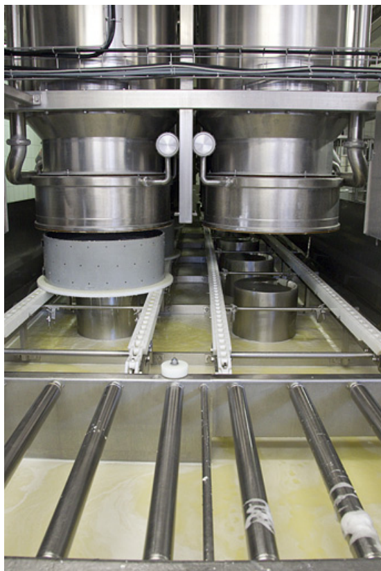
Fabrication du comté : installation de soutirage (cloches et moule). 25, Damprichard, 20 rue des Ecoles
