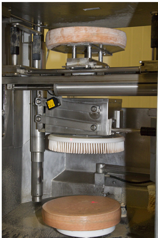
Fabrication du morbier : zone de travail du robot de soins, avec deux meules en place. 25, Damprichard, 20 rue des Ecoles
