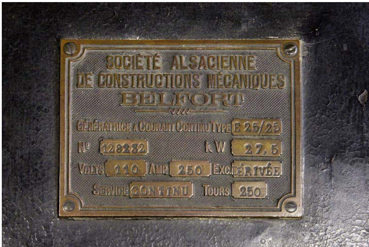
Centrale : plaque signalétique de l'excitatrice.
