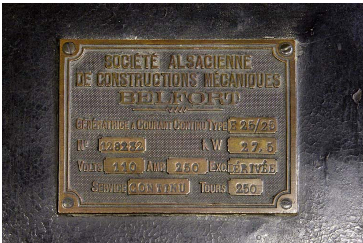
Centrale : plaque signalétique de l'excitatrice.
