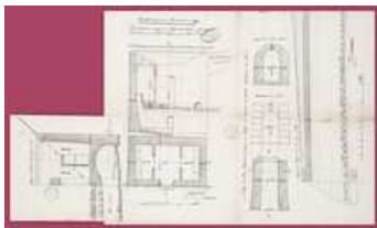
Plan, élévation et coupe pour la construction des latrines pour les soldats : volet de gauche ouvert.
