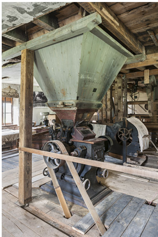
Broyeur à cylindres Goulut-Borne.
