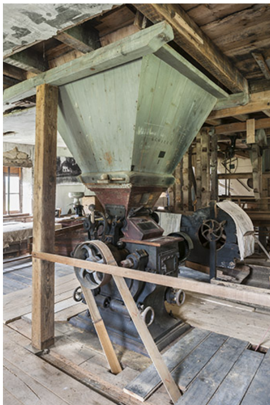
Broyeur à cylindres Goulut-Borne.
