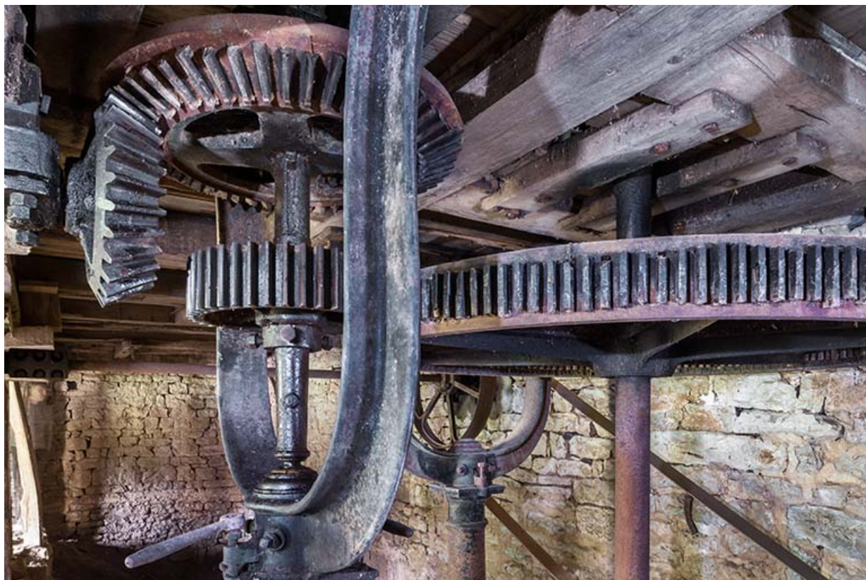
Détail des engrenages du beffroi de moulin.
