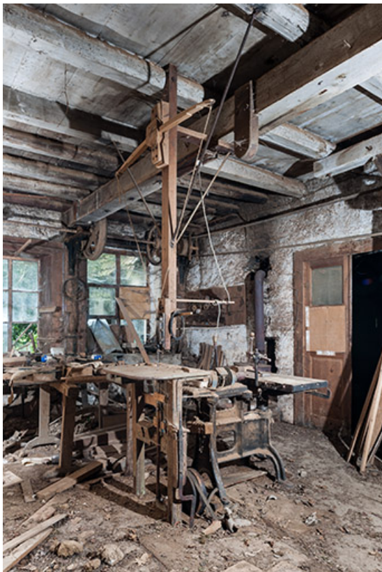
Atelier à l'étage de soubassement. Scie "arbalète" alternative et machine à mortaiser. 25, Sancey-le-Long, 8 rue de Lattre de Tassigny
