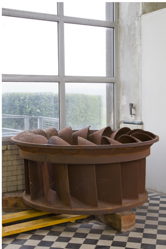
Turbine Francis déposée.
