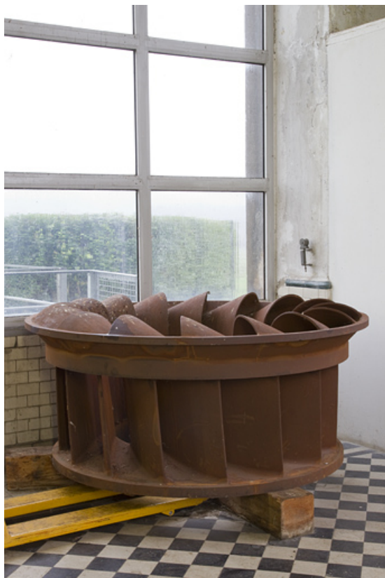
Turbine Francis déposée.
