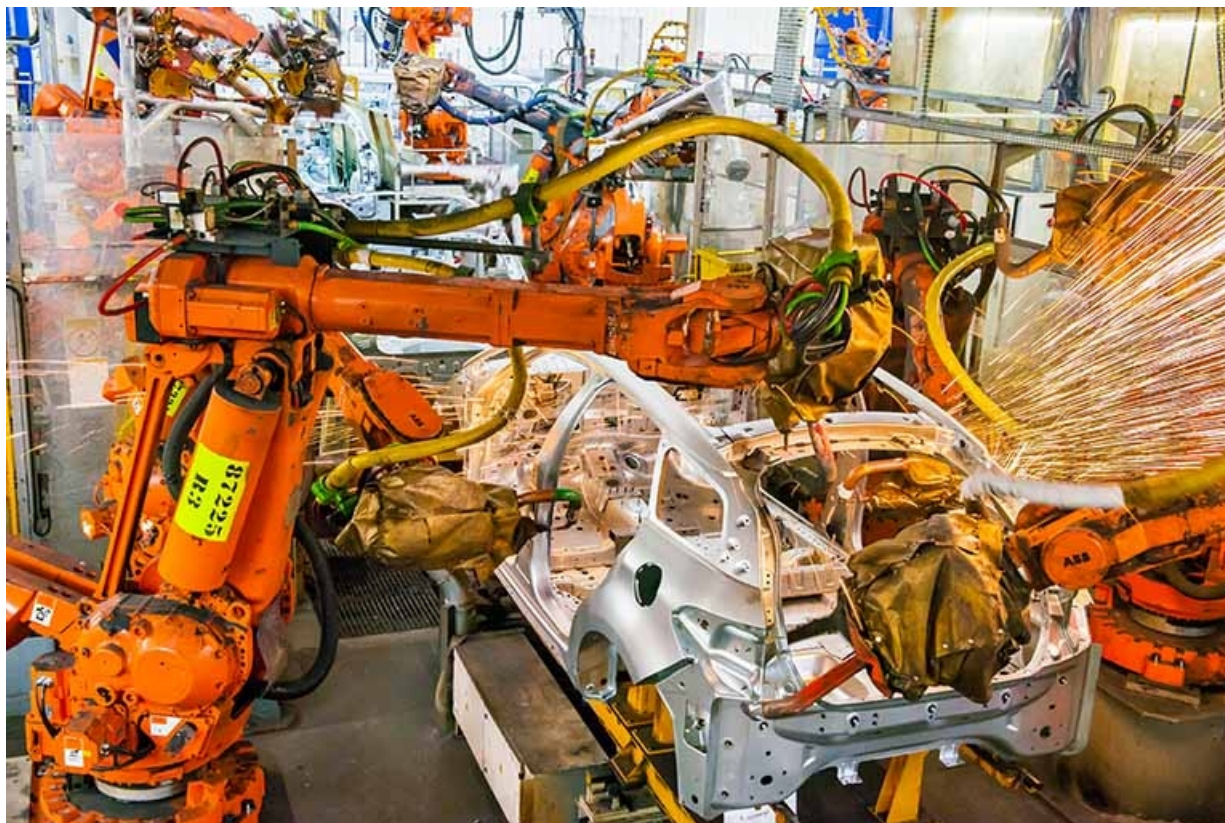
Atelier de ferrage. Robots de soudage sur la caisse en blanc (3).
