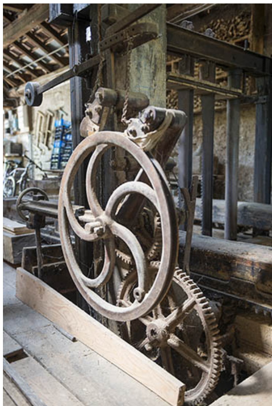
Châssis de scie (ou haut-fer) : volants de transmission du mécanisme. 25, Rémondans-Vaivre, 14 rue du Moulin
