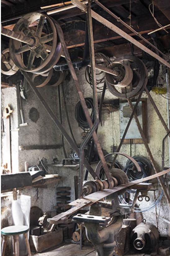
Affûteuse avec son mécanisme de transmission.
