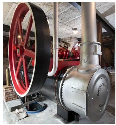
Détail du volant d'inertie et de la porte du foyer.
