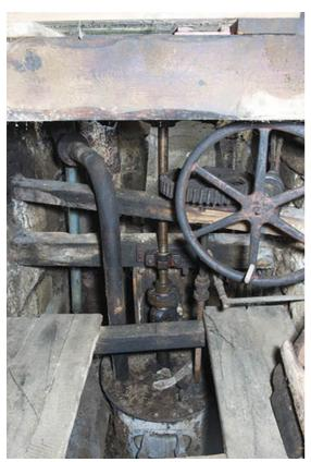
Mécanisme de débrayage de la turbine (visible en bas). 25, Rémondans-Vaivre, 14 rue du Moulin
