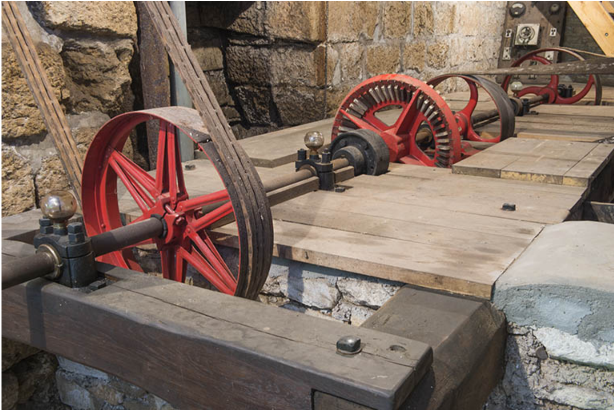
Arbre de transmission et poulies de renvoi.
