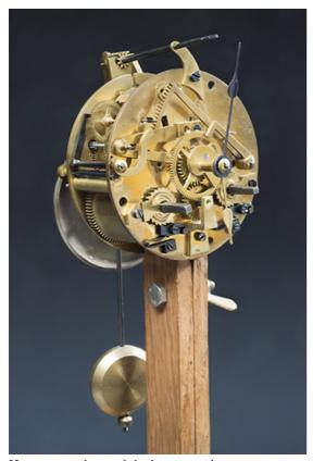
Mouvement de pendule Japy monté sur support.
