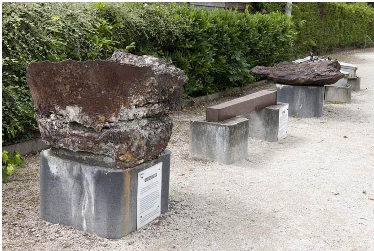
Pièces diverses exposées à proximité du site : loup (ou laitier, résidus agglomérés issus du démoulage) et lingot d'acier. 25, Audincourt rue du Four Martin, lieudit : les Forges
