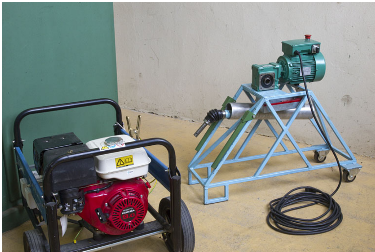
Groupe électrogène et appareil électrique de secours (commande du vannage).
