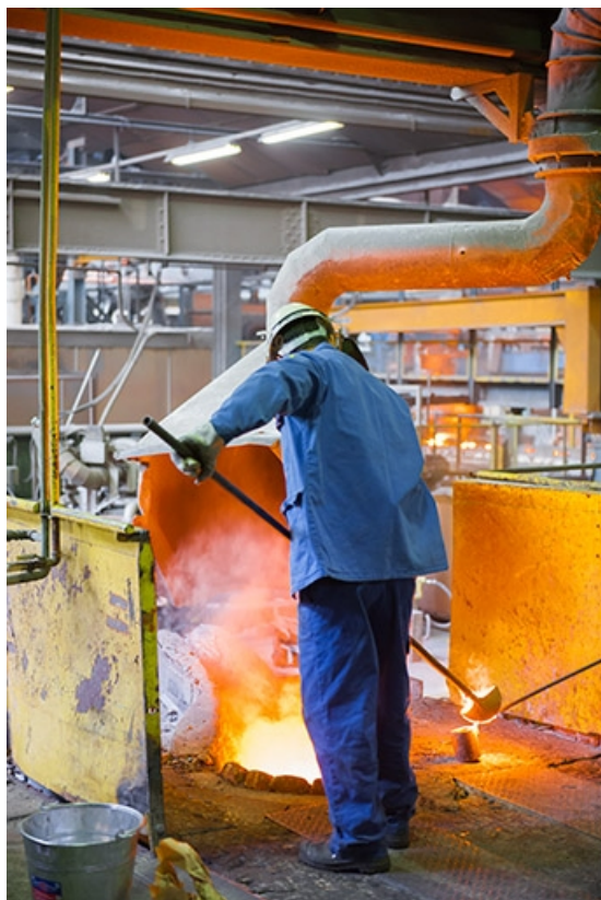
Prélèvement de matière en fusion dans un four à induction (2). 25, Colombier-Fontaine, 2 rue du Doubs
