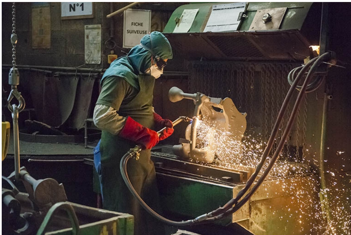
Découpage de pièces au chalumeau (2). 25, Colombier-Fontaine, 2 rue du Doubs
