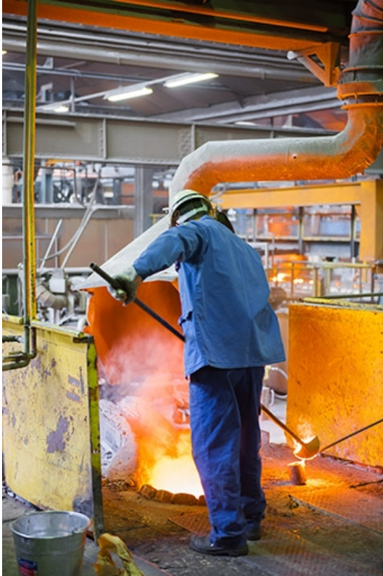
Prélèvement de matière en fusion dans un four à induction (2).
