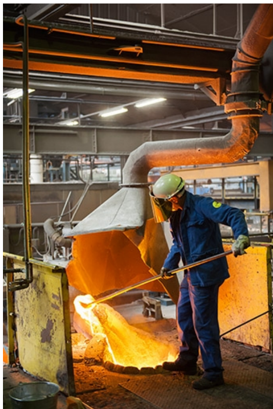
Prélèvement de matière en fusion dans un four à induction (4).
