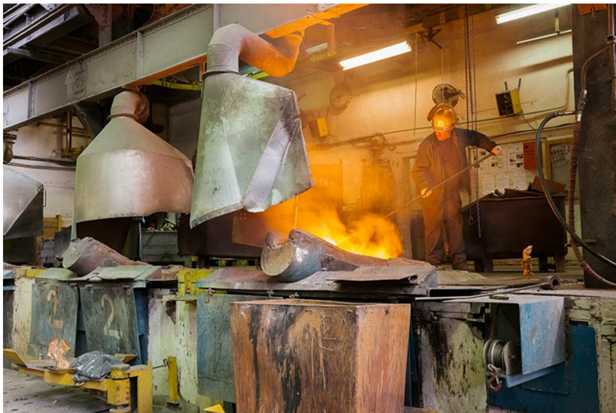
Prélèvement dans un four à induction.
