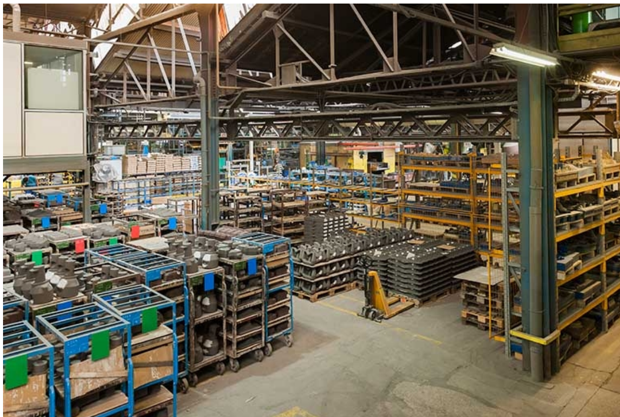
Aire de stockage des modèles et des noyaux (2).
