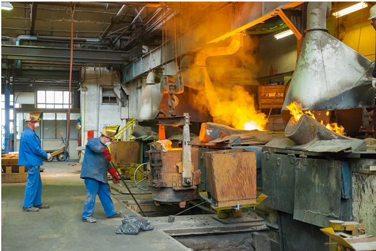
Fours à induction. Préparation d'une coulée.
