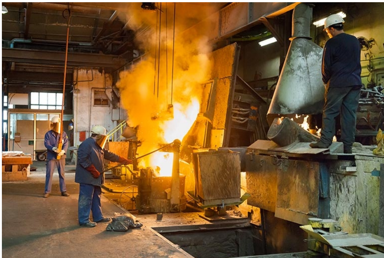
Bascule d'un four à induction dans une poche.
