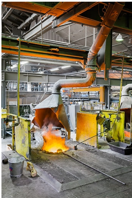
Four à induction en service.
