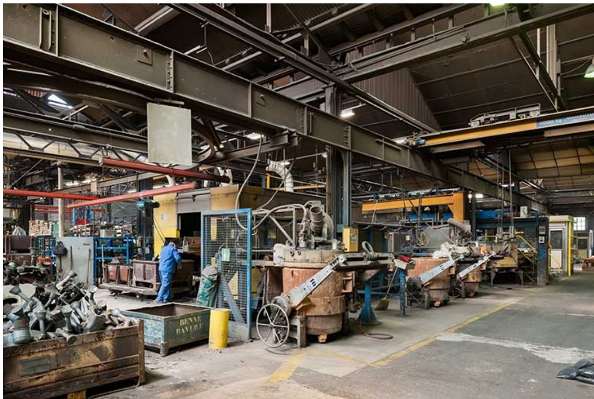
Vue d'ensemble. Poste de décochage et poches de coulée.
