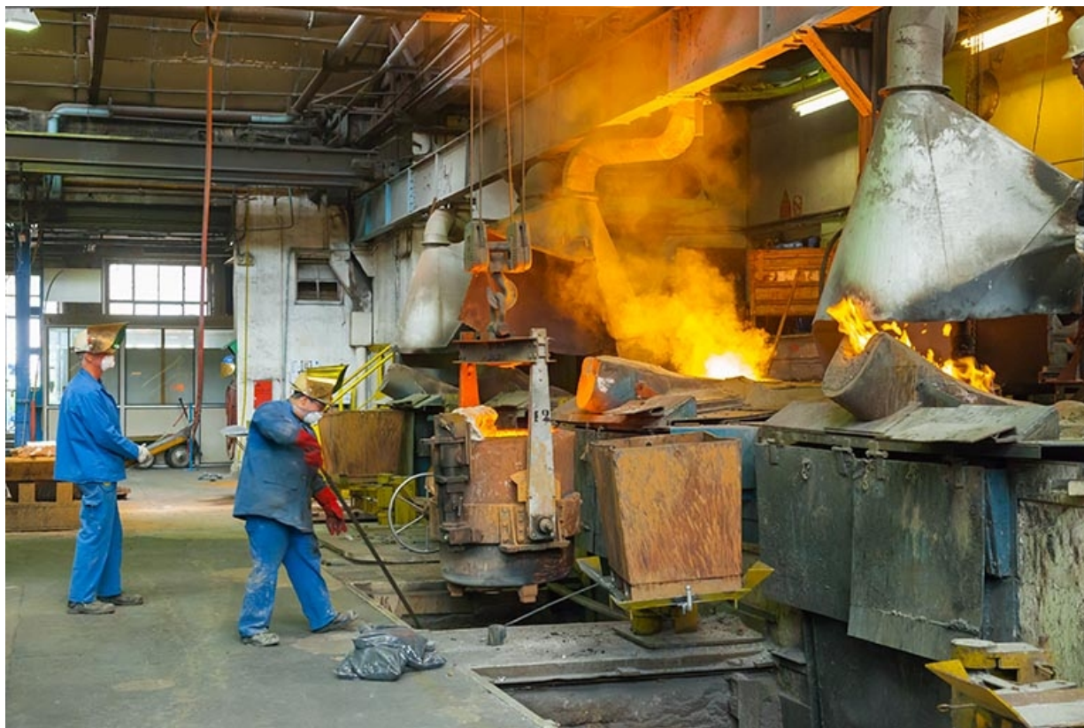
Fours à induction. Préparation d'une coulée.
