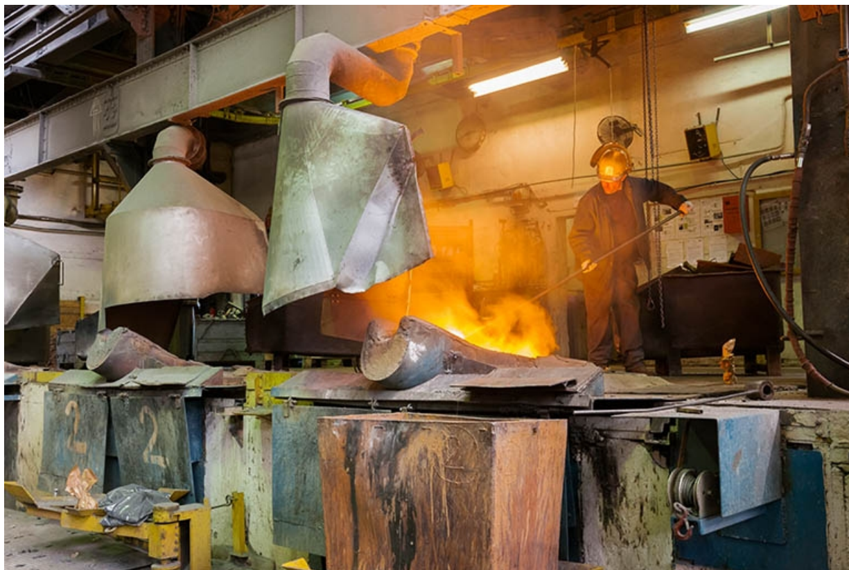
Prélèvement dans un four à induction.
