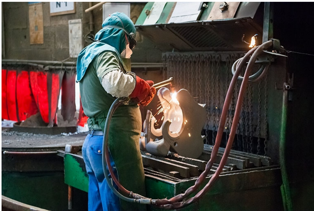
Découpage de pièces au chalumeau (3). 25, Colombier-Fontaine, 2 rue du Doubs
