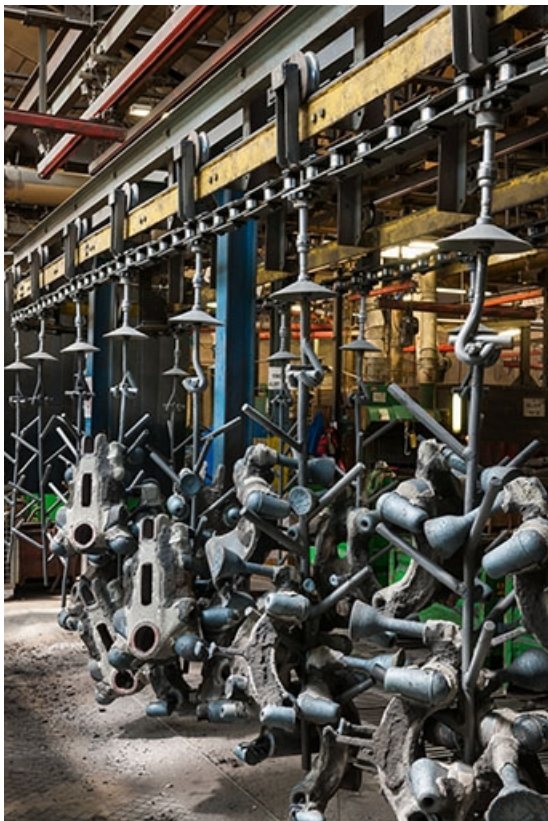
Pièces au dessablage (grenailleuse).
