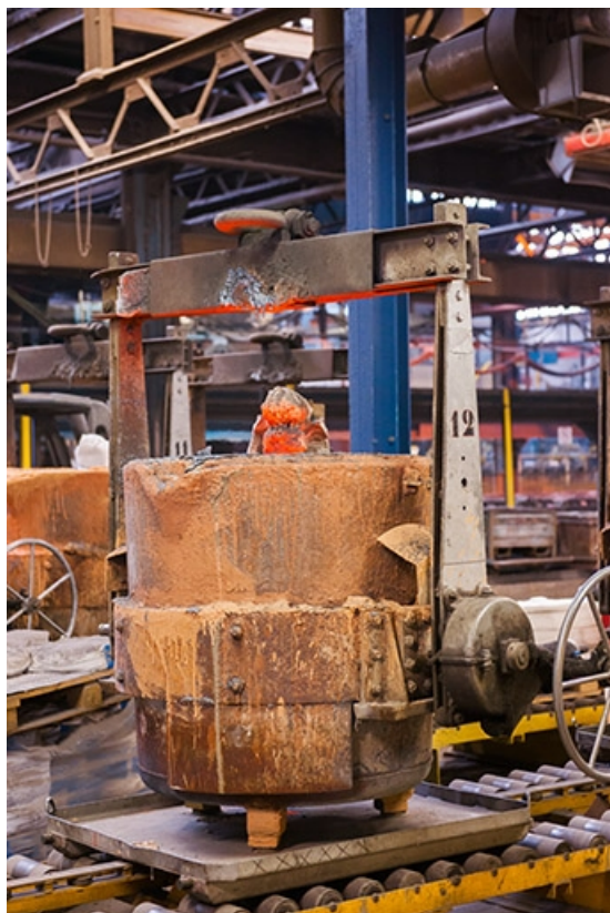
Poche de coulée avant réfection.
