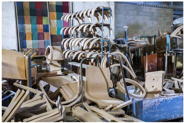
Pièces inachevées entreposées dans l'atelier de pliage.
