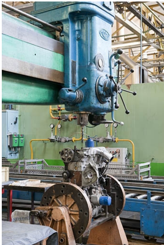
Atelier de rénovation des moteurs. Détail de supports de la chaîne de montage (désaffectée).
