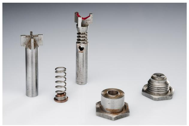
Gicleurs d'amortisseurs, ressorts et sièges de clapet.
