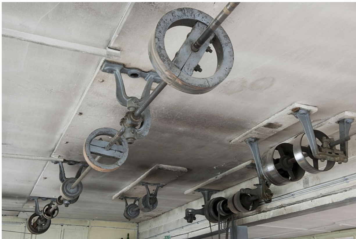
Intérieur de l'atelier. Système de transmissions.
