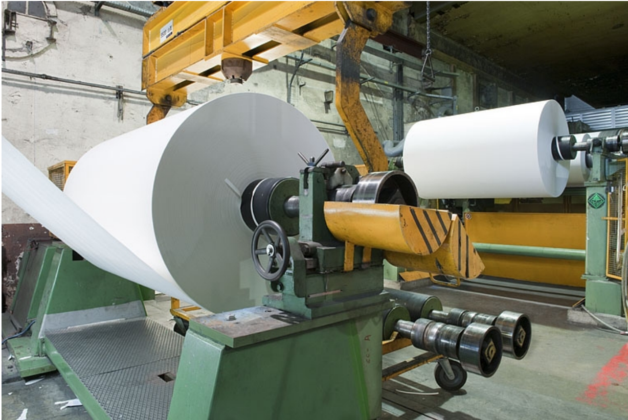
Partie aval de la machine à papier : bobineuses.
