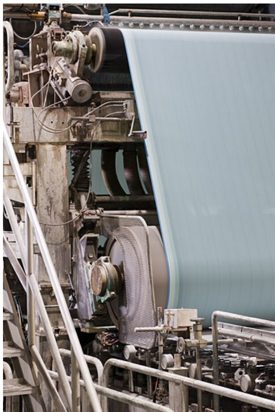
Machine à papier. Détail de la table de fabrication.
