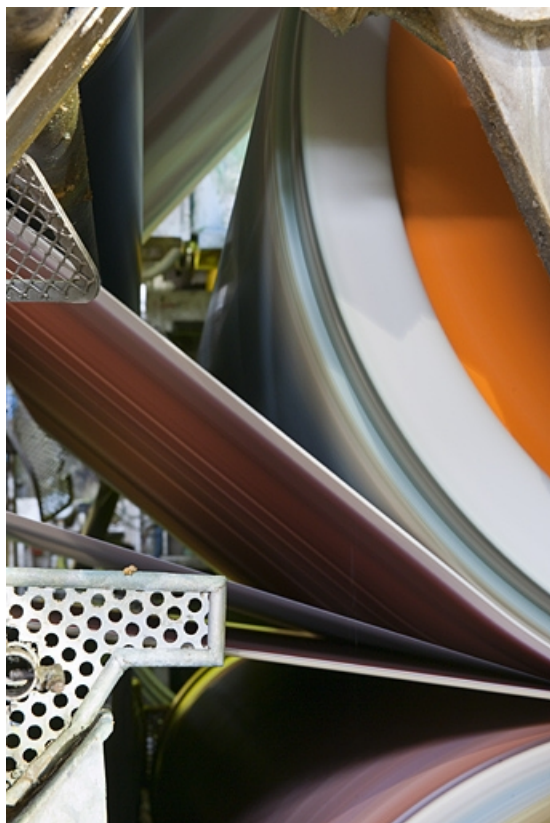
Passage de la feuille de papier entre les cylindres de pressage et d'égouttage. Détail. 25, Mandeure, 14 rue de la Papeterie
