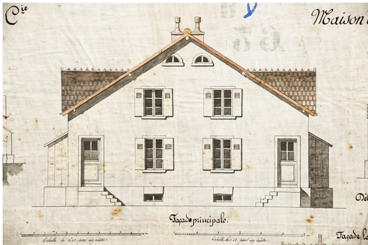
Cité Constant Peugeot et Cie. Maison à quatre logements. Façade principale.
