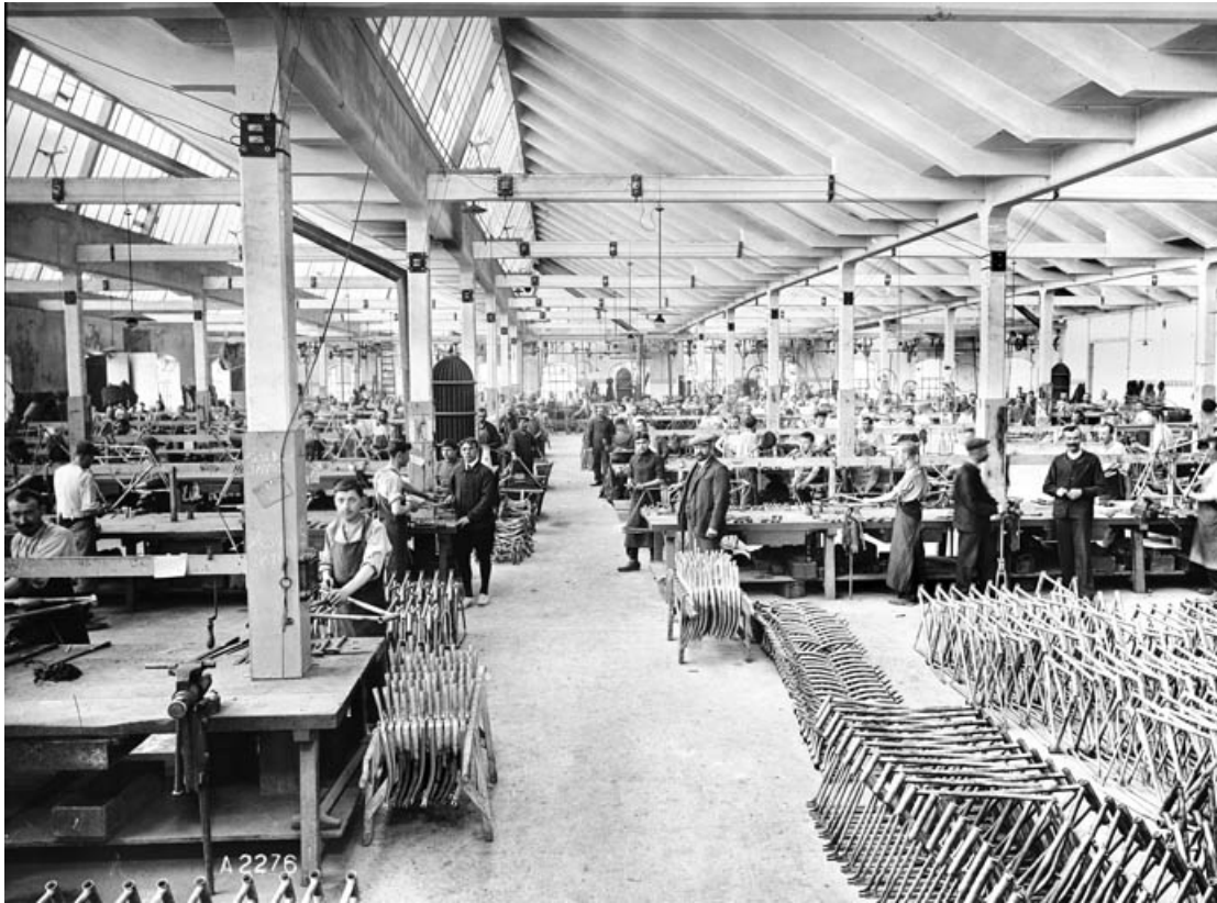
Atelier de fabrication de cadres de bicyclettes.
