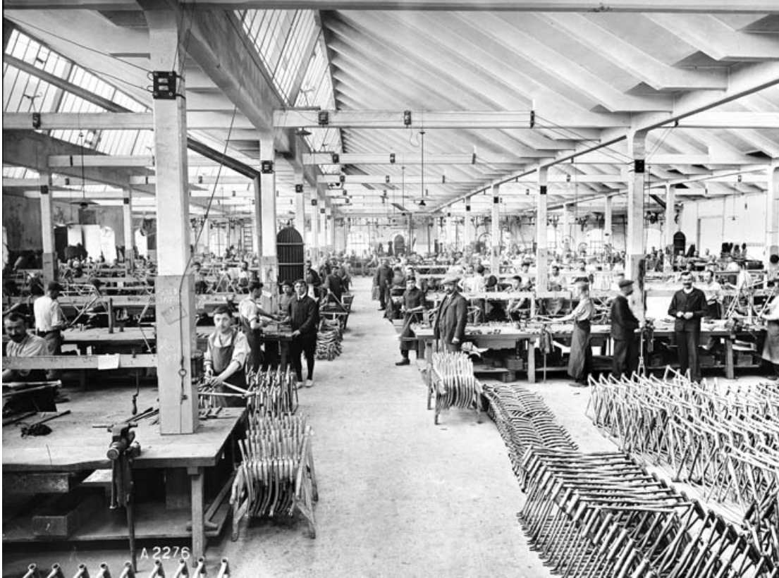
Atelier de fabrication de cadres de bicyclettes.
