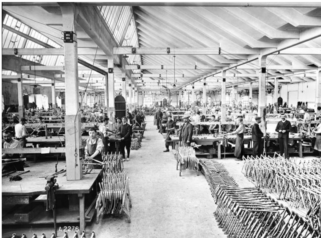
Atelier de fabrication de cadres de bicyclettes.
