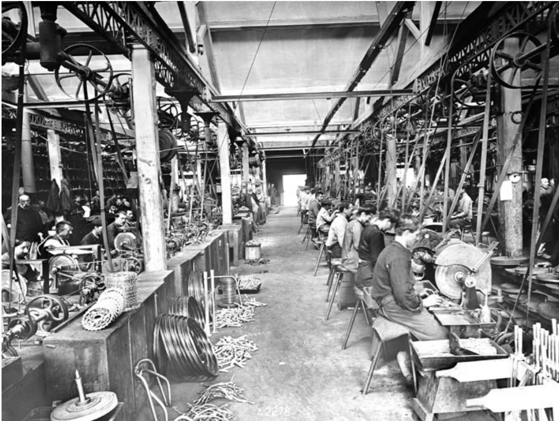
Atelier de polissage de pièces pour bicyclettes.
