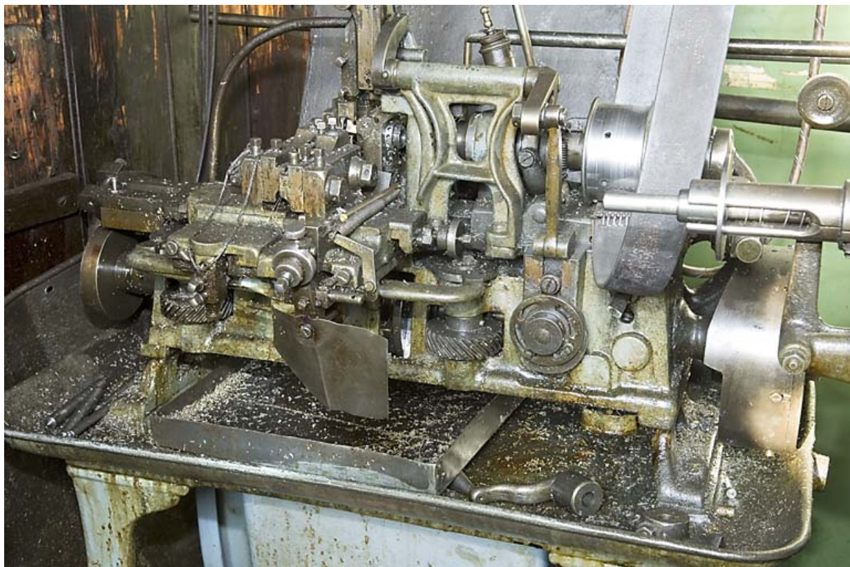
Tour à décolleter Beldi (L). 25, Besançon, 11 rue Larmet
