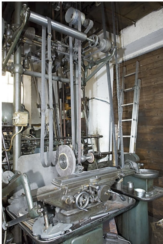
Rectifieuse cylindrique FSGT (F) et tour à meuler (E). 25, Besançon, 11 rue Larmet
