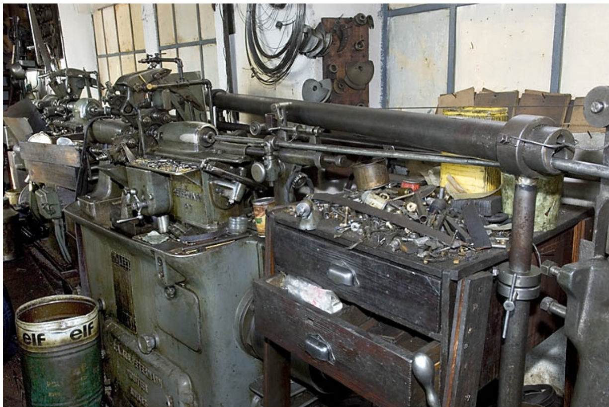
Tours à décolleter Petermann (O) et André Bechler (P). 25, Besançon, 11 rue Larmet
