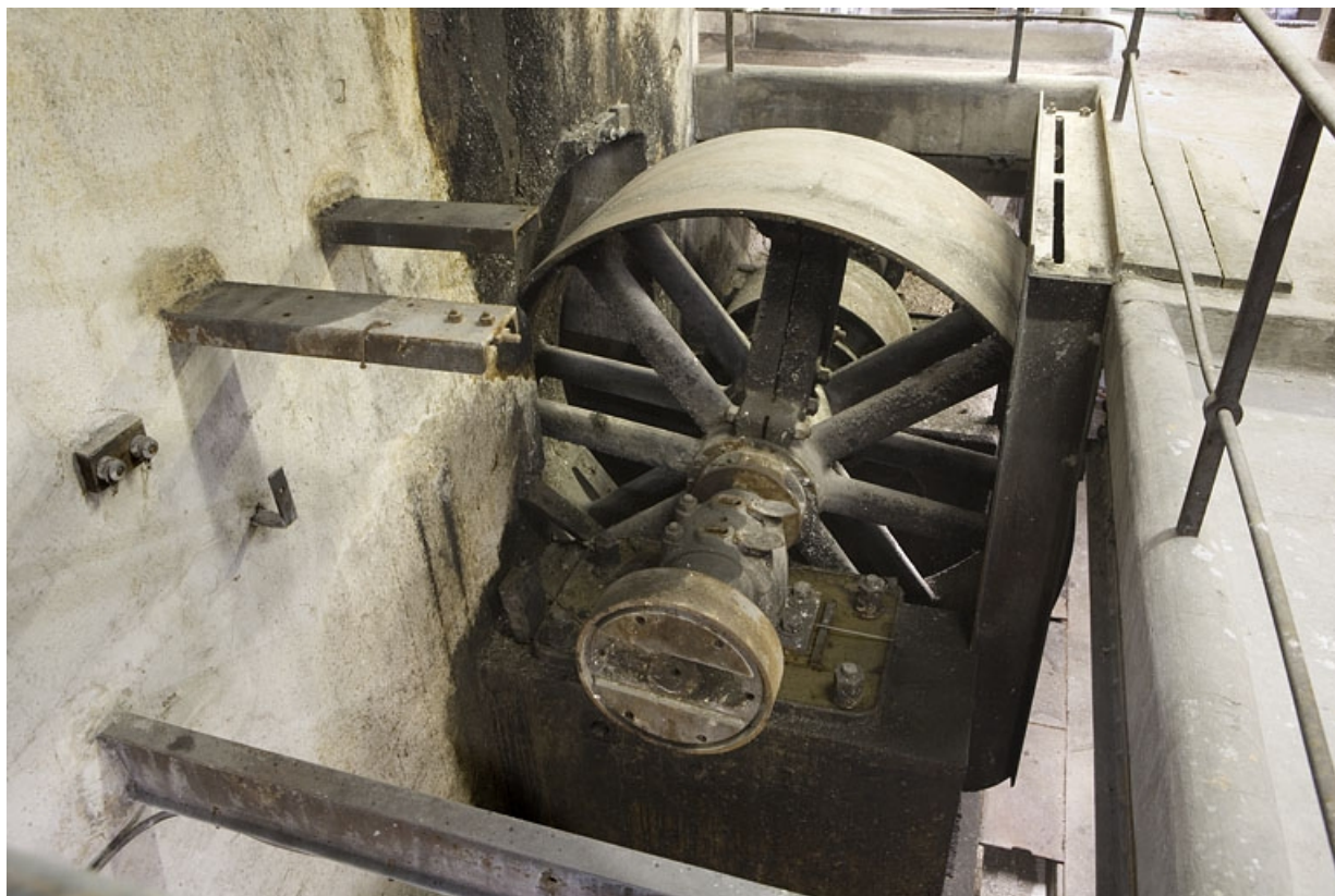
Atelier de fabrication (premier étage). Volant de transmission (hors service). 25, Boussières rue Ernest Zuber
