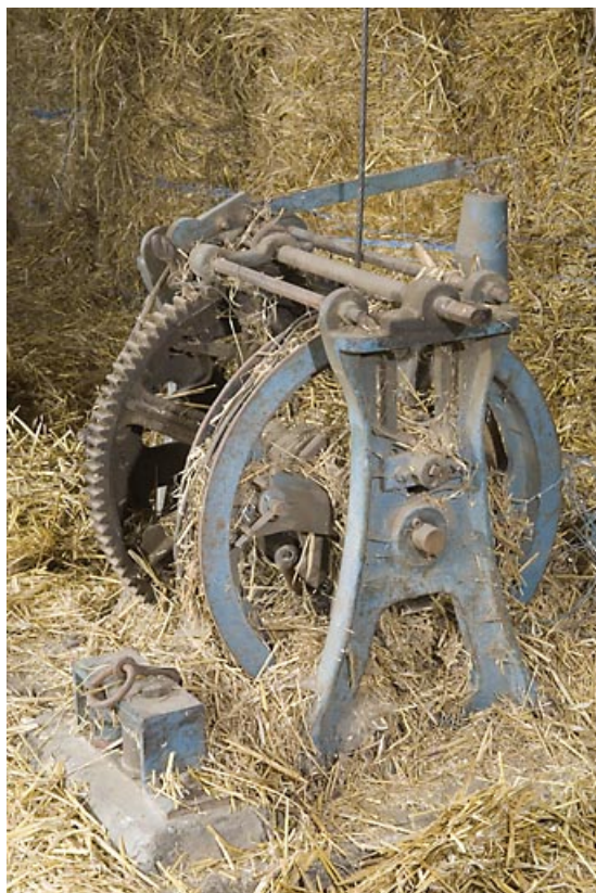
Grange haute : treuil de la déchargeuse.
