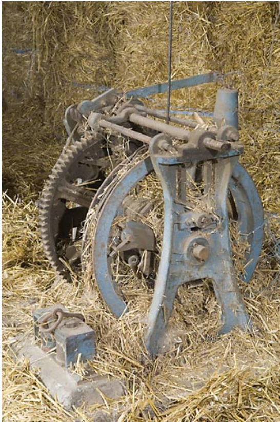
Grange haute : treuil de la déchargeuse.
