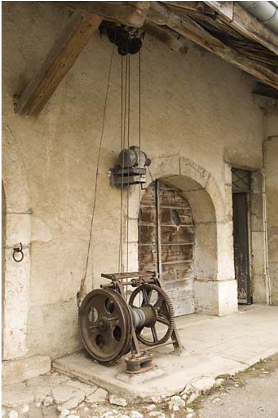
Déchargeuse : vue d'ensemble du treuil.
